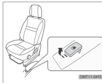
1. Para abrir la tapa de llenado de combustible, tire de la palanca de liberación hacia arriba.
