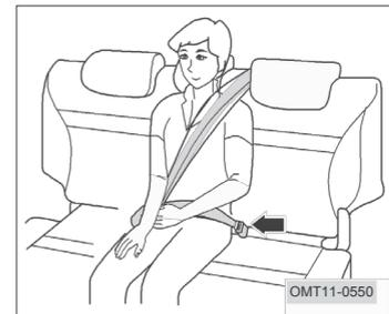
El cinturón central del asiento trasero es una restricción de tipo de tres puntos con dos hebillas. Ambas hebillas de los cinturones de seguridad deben estar correctamente ubicadas y bien cerradas para un correcto funcionamiento.
