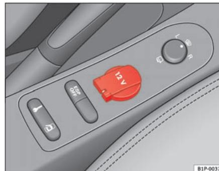
Fig. 101 Toma de corriente consola central delantera
