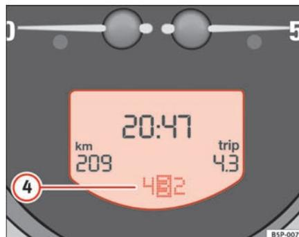
Fig. 36 Detalle del cuadro de instrumentos: pantalla con indicador de marchas del Tiptronic
