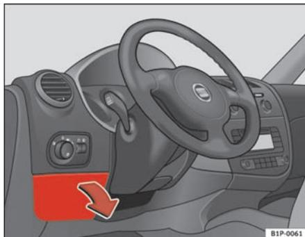
Fig. 161 Tapa de la caja de fusibles en el lado izquierdo del tablero de instrumentos
