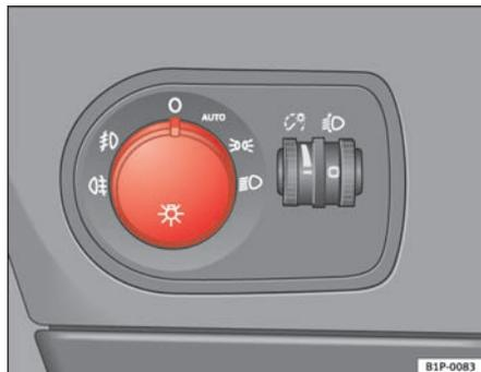
Fig. 73 Encendido automático de luces
