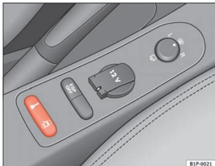
Fig. 59 Detalle de la consola central: pulsador del cierre centralizado
