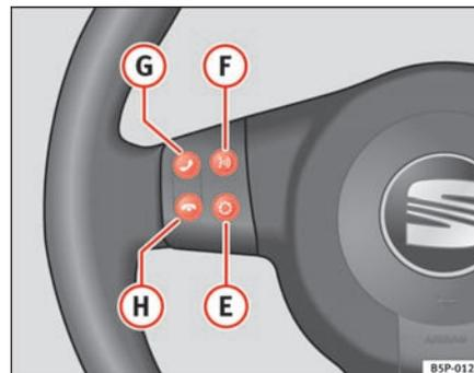
Fig. 55 Mandos en el volante Audio + Teléfono
