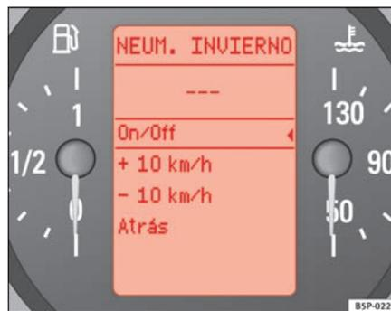
Fig. 45 Pantalla digital del cuadro de instrumentos: indicador de neumáticos invierno
