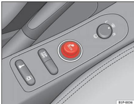
Fig. 100 Encendedor alojado en la toma de corriente de la consola central anterior
