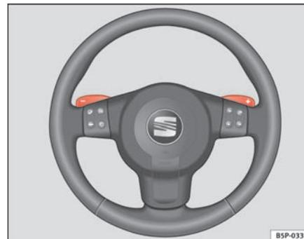
Fig. 124 Volante con palancas para cambio automático
