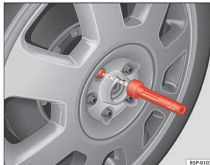
Fig. 159 Cambio de rueda: Útil de hexágono interior para girar los tornillos
