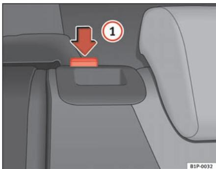
Fig. 94 Levantar el respaldo del asiento trasero
