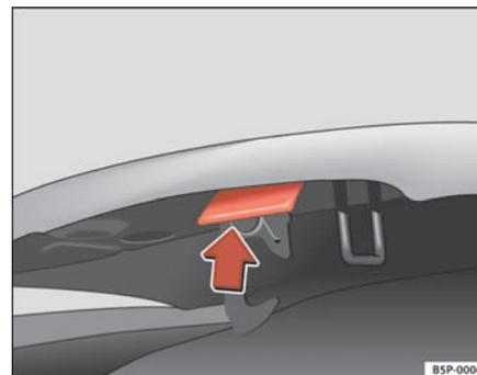
**Fig. 143** Gancho apertura capó motor. ▶
