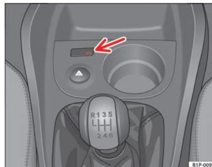
Fig. 26 Testigo de control de la desactivación del airbag del acompañante
