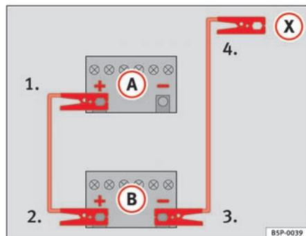
Fig. 181 Esquema de conexión de los cables de emergencia
