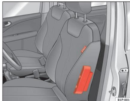
**Fig. 21** Airbag lateral en el asiento del conductor
