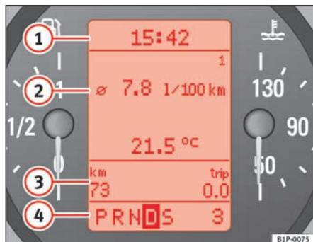
Fig. 37 Pantalla digital del cuadro de instrumentos
