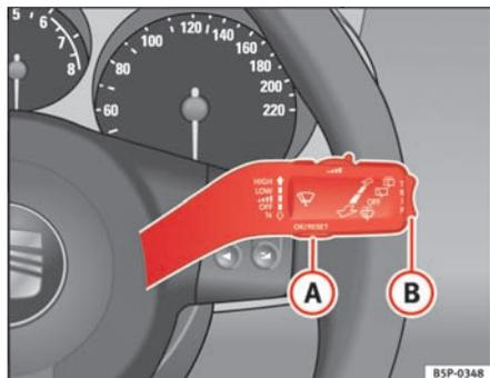
Fig. 40 Palanca del limpiacristales: tecla A y tecla basculante B
