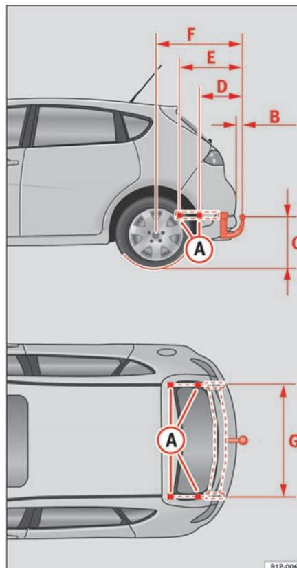
Fig. 140 Puntos de fijación del dispositivo de remolque
