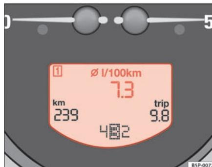
Fig. 39 Pantalla digital del cuadro de instrumentos: indicador consumo medio de combustible
