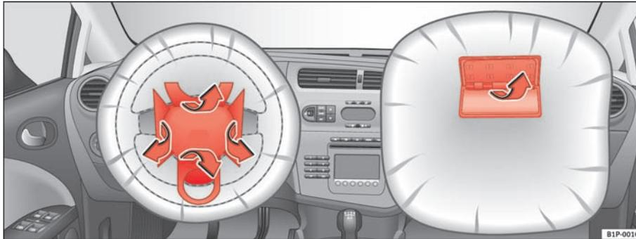
Fig. 20 Cubiertas de los airbags al dispararse los airbags frontales
