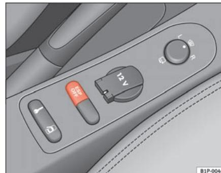
**Fig. 115** Detalle de la consola central: tecla ESP
