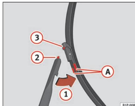
Fig. 149 Cambio de las escobillas del limpiaparabrisas
