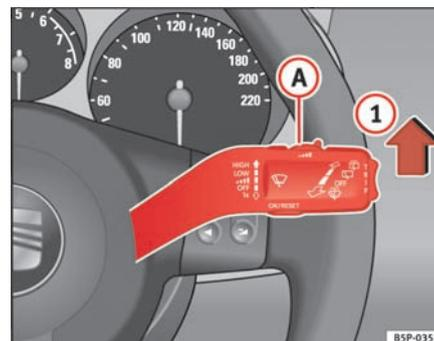
Fig. 84 Palanca del limpiaparabrisas
