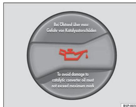
**Fig. 146** Tapón de la boca de llenado de aceite del motor en el vano motor
