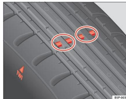
Fig. 152 Indicadores de desgaste del perfil del neumático
