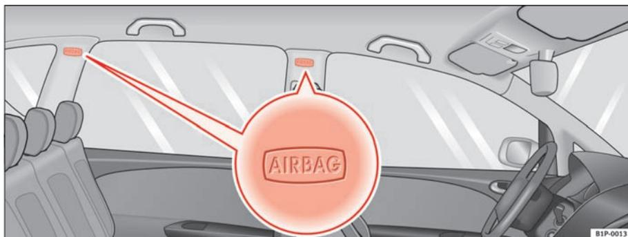
**Fig. 23** Ubicación de los airbags para la cabeza en el lado izquierdo del vehículo
