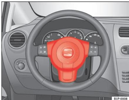
**Fig. 17** Airbag del conductor en el volante
