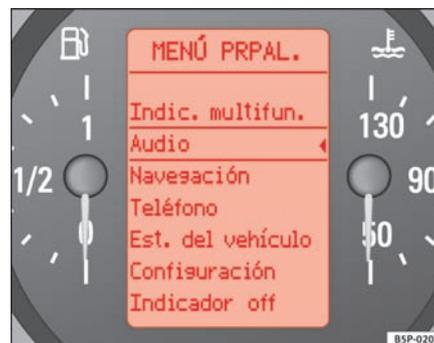
Fig. 43 Pantalla digital del cuadro de instrumentos: Menú principal
