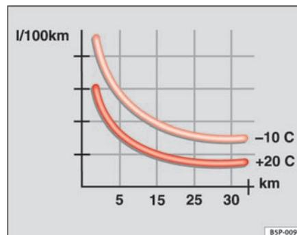
Fig. 139 Consumo de combustible (l/100 km) a dos temperaturas ambiente
