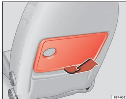
Fig. 97 Mesita plegable del asiento delantero izquierdo
