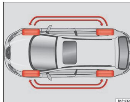
Fig. 153 Esquema para el cambio de ruedas
