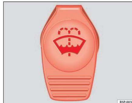
**Fig. 148** Tapón del depósito del lavacristales en el vano motor.
