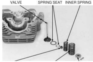
STEM SEAL OUTER SPRING SPRING RETAINER
