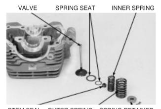
STEM SEAL OUTER SPRING SPRING RETAINER
