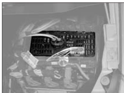
Fusibles bajo capó motor
