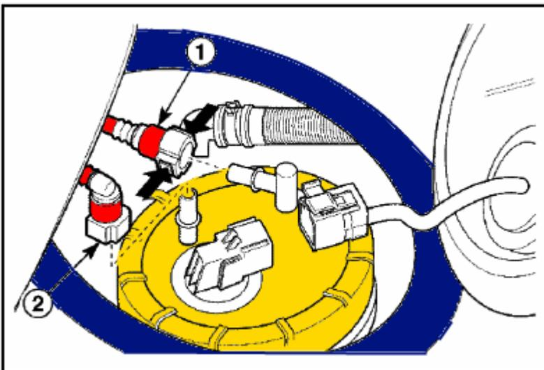
Ahora remueve las mangueras de entrada salida de la bomba de combustible- que se encuentran en rojo en el anterior dibujo, debes presionar con las yemas de los dedos índice y pulgar simultáneamente los seguros, tal como se muestra en el dibujo adjunto.
