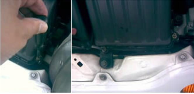
Retira con cuidado el cable del conector del sensor de aire, tiene un seguro que debe ser presionado en mi caso. Puede ser que tu auto tenga una variante en que sea necesario levantar el seguro y luego retirar el conector:
