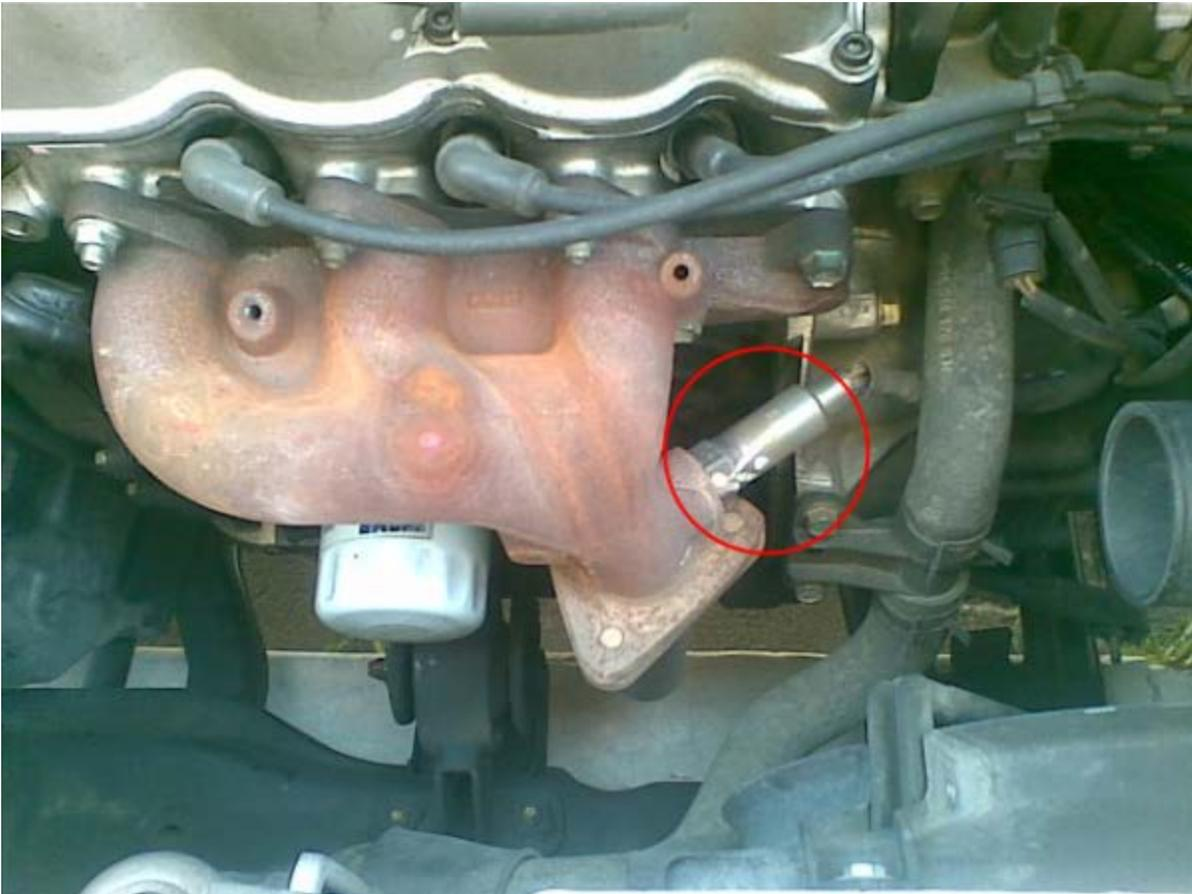
Los sensores de oxígeno o sensores lambda de dos terminales deben esperar a que el motor alcance la temperatura normal de operación para lograr sus función correctamente, y esto sucede en un par de minutos.
