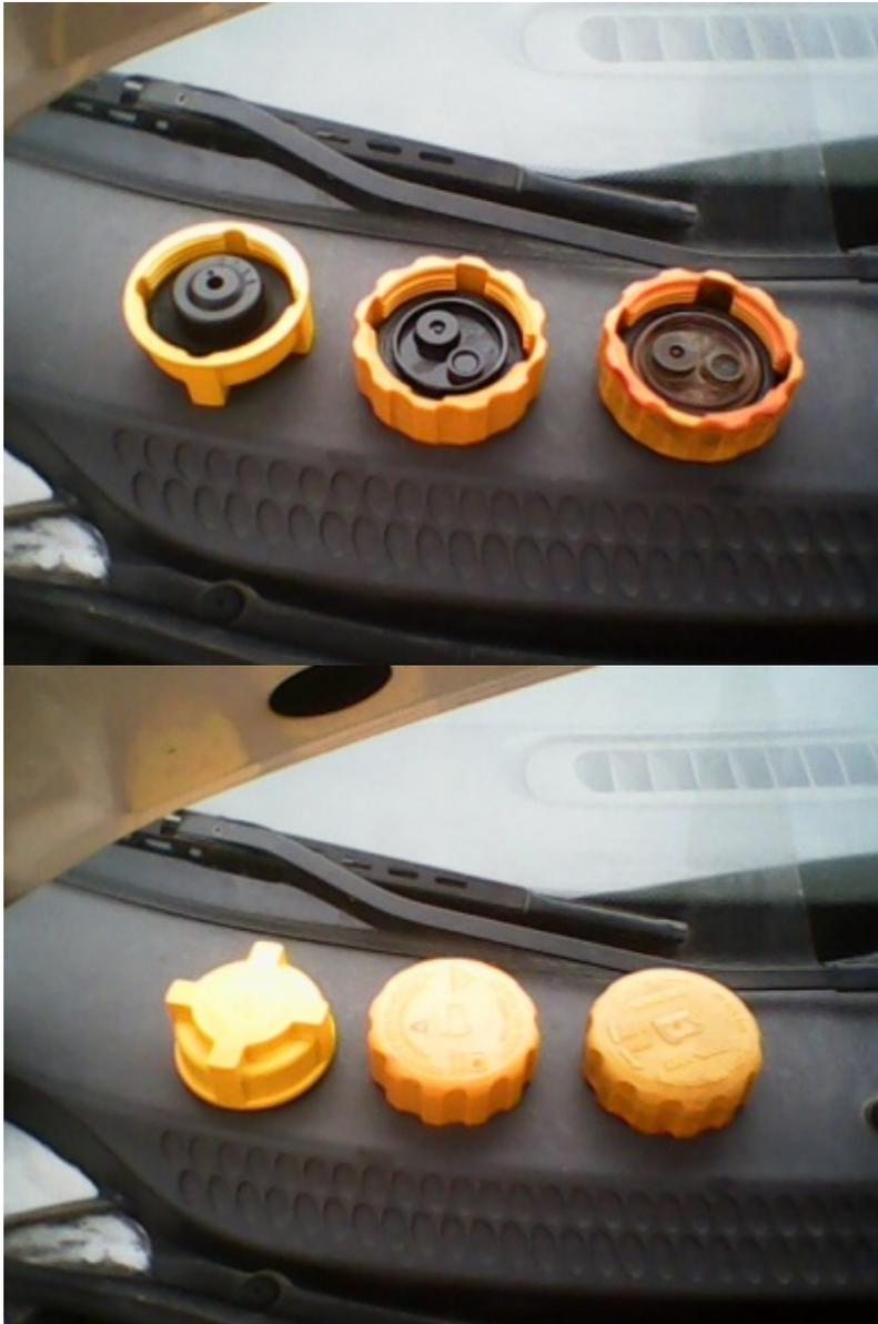
Después de uno o dos años de funcionamiento de nuestro automóvil se han acumulado restos de refrigerante así como del agua empleada en la mezcla del líquido refrigerante del motor.
