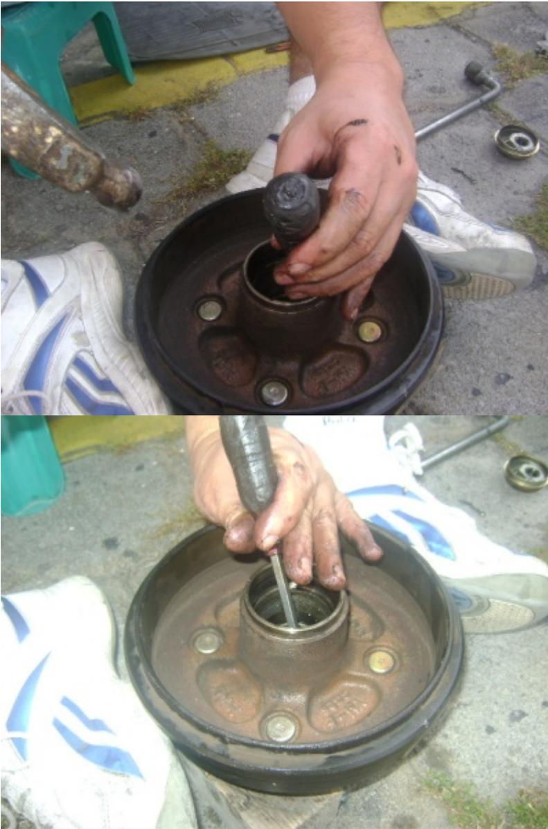
Retirar el retenedor y rodamiento interior golpeándolos con un cincel y/o destornillador sobre un par de bloque de madera tal como los de las fotografías.
