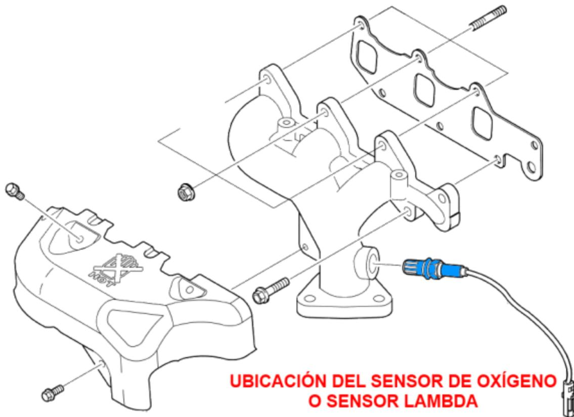
Como muestra este dibujo, el sensor de oxígeno o sensor lambda se encuentra en la salida del escape, justo después que se unen los ductos de expulsión de cada uno de los tres cilindros( o cuatro cilindros para las versiones de 1000cc).
