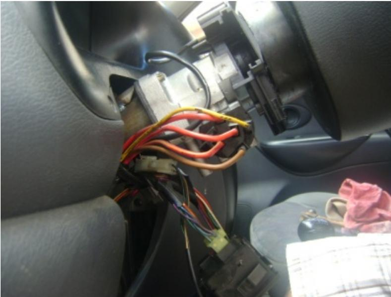
Para remover el zócalo y su cableado es necesario usar un destornillador plano mediano para levantar el seguro que retiene el zócalo del interruptor de encendido, luego se aplica fuerza y se balancea de lado a lado para que se afloje el zócalo. No es necesario retirar los cables del zócalo del interruptor de encendido.
