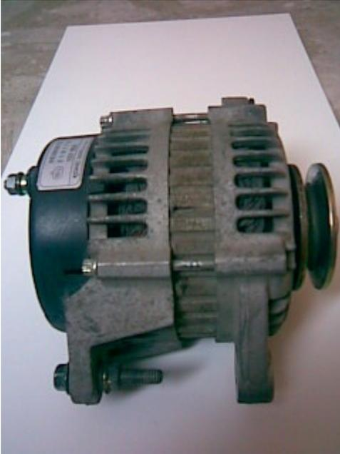
No olvides desconectar el borne positivo del generador/alternador, va conectado en perno con tuerca mostrado a la izquierda junto a la etiqueta color plata de la fotografía anterior.
