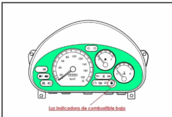
La hoja de especificaciones del Spark 0.8/1.0 litros nos indica que la capacidad del tanque de combustible es de 38 litros, esto es: 38 litros / 3,785 litros = 10 galones. La luz indicadora de combustible bajo, se enciende cuando queda alrededor de 1 galón de reserva.
