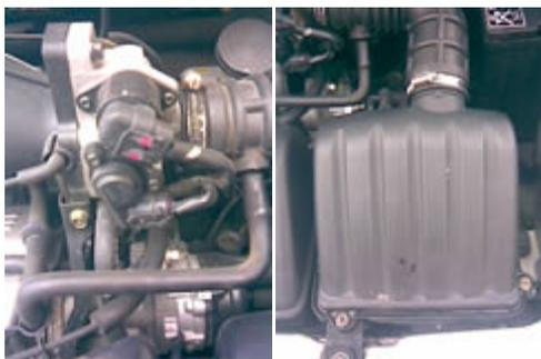
Con el destornillador estrella, suelta los dos tornillos de la tapa del filtro de aire:
