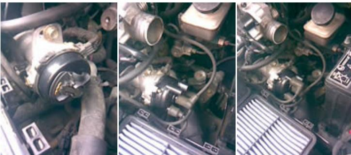
Monta la tapa del filtro de aire, asegúrala con los dos tornillos, luego inserta el conector del sensor de aire, inserta la manguera que tiene forma de "L", y asegura por último las dos abrazaderas:
