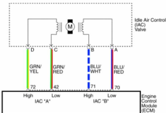
Este es el diagrama eléctrico de la válvula IAC, como se puede notar llegan cuatro cables desde el ECM para controlar los dos bobinados del motor de pasos.
