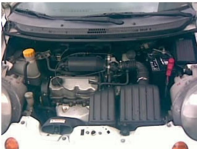
En esta imagen, tienes el filtro de aire con sus mangueras, abrazaderas y sensor:
