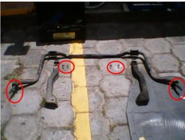
La fotografía ilustra la barra estabilizadora desmontada, los extremos se muestran sin los bujes.
