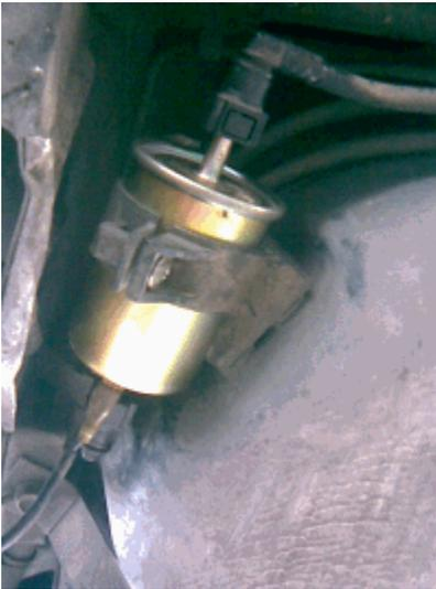
Es necesario manipular con cuidado las mangueras de combustible ya que se pueden dañar los conectores o bien las mangueras y cambiarlas o repararlas es bastante complicado.
