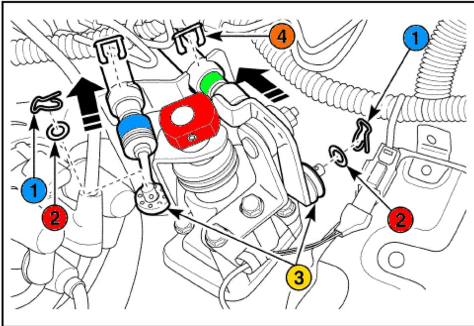
1. Horquillas o clips de fijación
