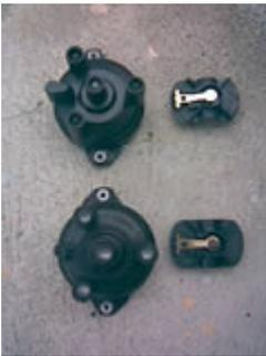
Inserta el rotor nuevo, preferiblemente en la misma posición original, monta la tapa nueva con los tornillos de la tapa vieja y asegúrala- con el tapón de desfogue de humedad hacia el fondo, conecta los cables en el mismo lugar original:
