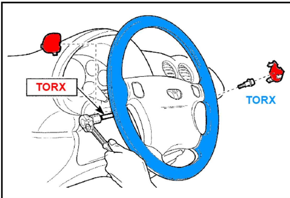
Desmontaje del air bag- en caso de tenerlo, o cubierta del pito
