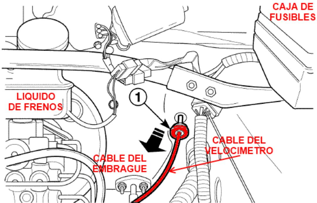
Podemos notar que el cable del velocímetro (1) está a la derecha del contenedor del líquido de frenos, arriba del cable del embrague (el que está sujeto con dos pernos) y debajo de la caja de fusibles.
