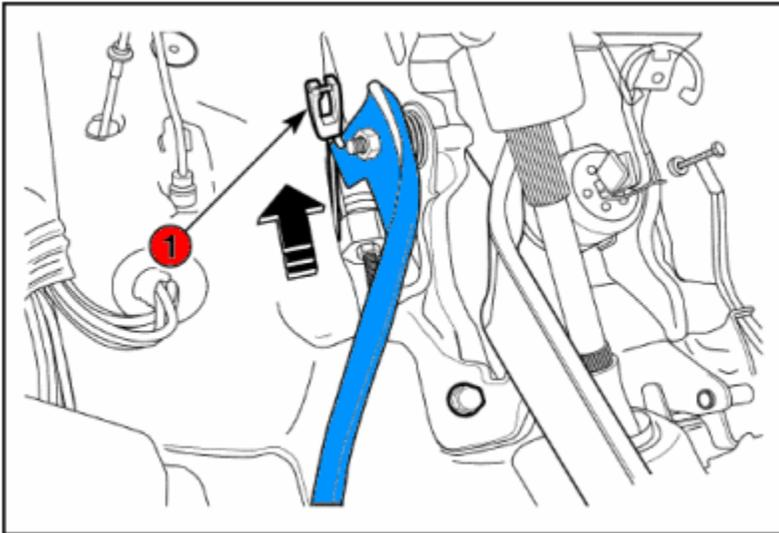
Debajo del puesto del conductor en el pedal de embrague se remueve el pivote del cable del embrague del gancho.
