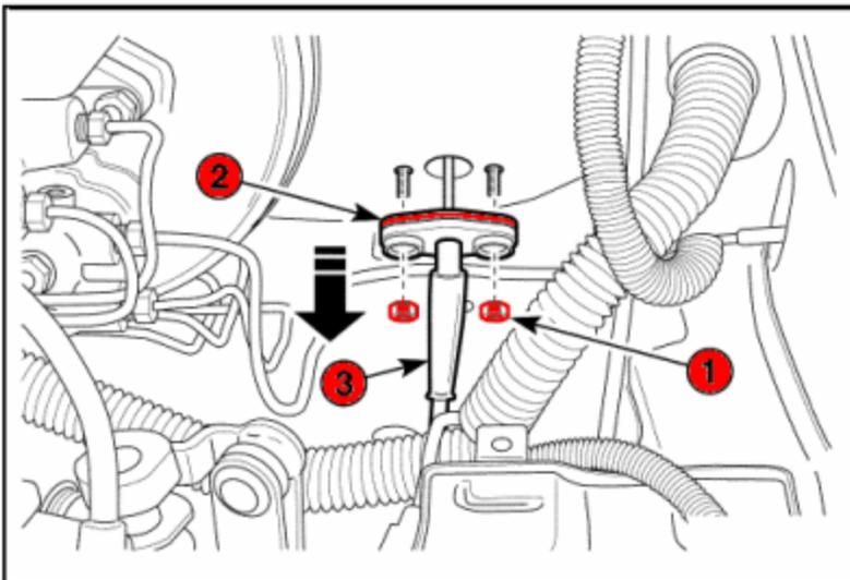
Antes de proceder a retirar el cable definitivamente, desconecta la batería para evitar cualquier accidente, luego aflojar y retira las tuercas (1), retira el separador (2) y remueve el cable en su totalidad.
