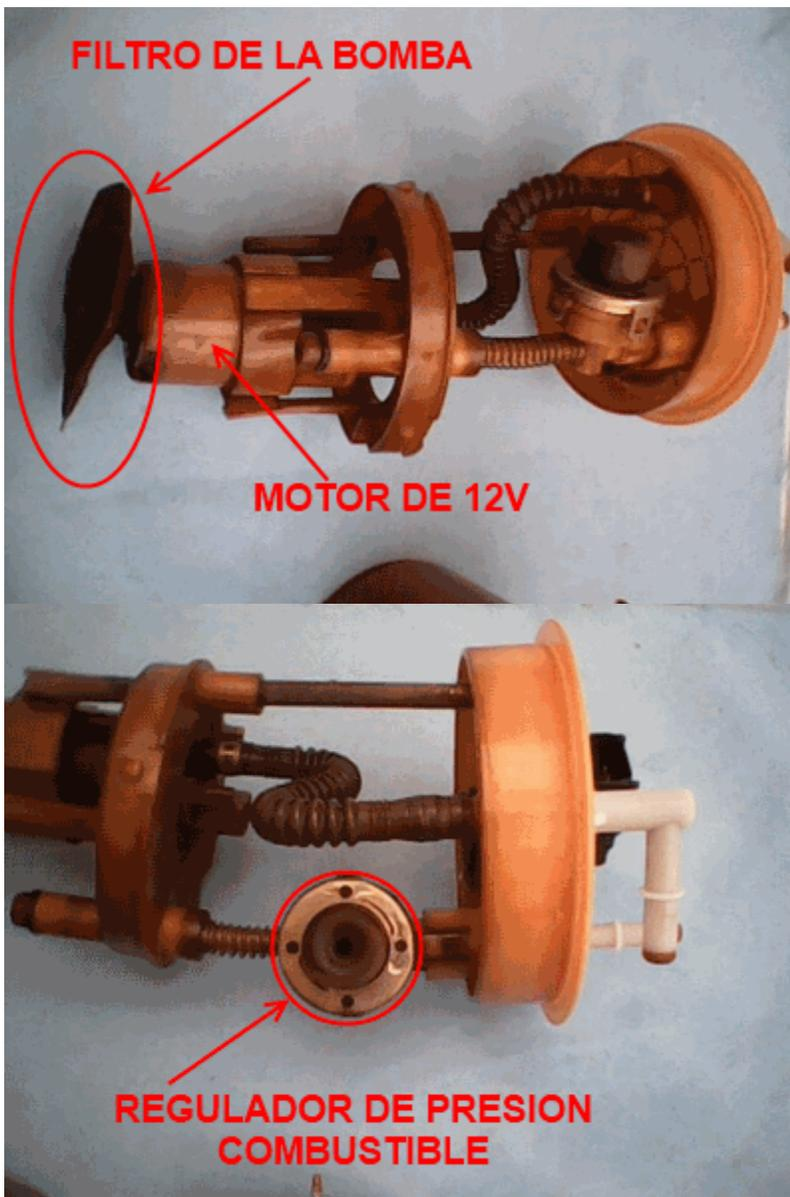
El proceso de armado se lo hace a la inversa, tener especial cuidado en ubicar correctamente el sello de caucho antes de asegurar la tapa del tanque, poner el conector de la bomba con los seguros, las mangueras de entrada y salida de la bomba deben estar bien sujetos- poner atención al click al insertarlos.
