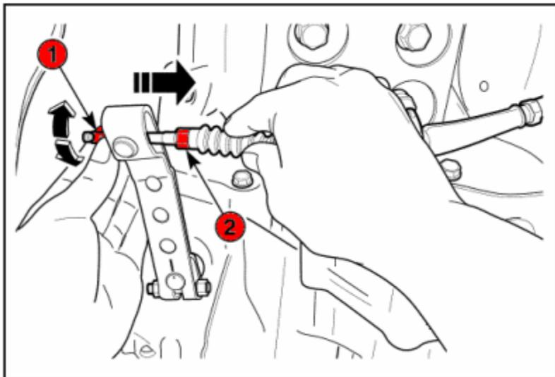
*Para desmontar el cable de embrague del brazo, sujetarlo y muévelo con la mano derecha. Con la mano izquierda quita la rosca que lo sostiene. Esta vista corresponde a la parte delantera inferior, debajo del radiador del automóvil.*
