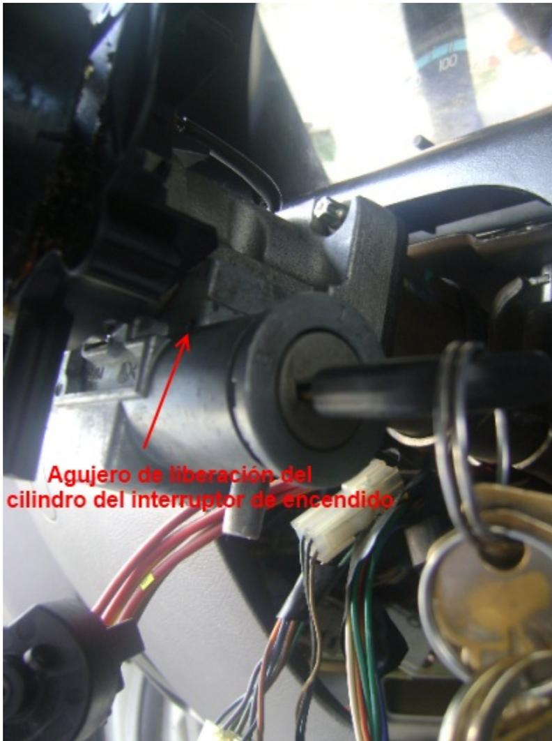
La fotografía anterior muestra el vástago del cilindro del interruptor de encendido roto, por lo que es necesario reemplazar todo el cilindro- lo que se traduce en que ahora será necesario una llave para las puertas y otra para el encendido. Aunque existe la posibilidad de intercambiar las fichas del cilindro viejo hacia el nuevo de modo de mantener la misma llave, esto debe hacerse con sumo cuidado pero es posible hacerlo.
