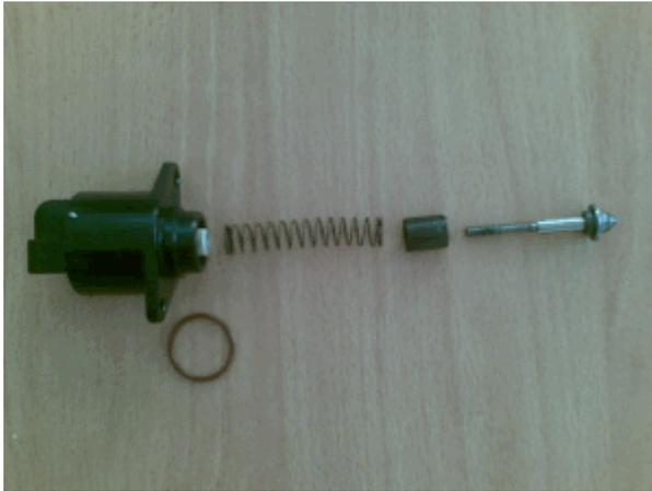
Una de las principales fallas que ocasiona la válvula IAC sobre el motor de un automóvil es que se apague al momento de estar en ralentí o producir temblores en el automóvil al tratar de apagarse, ocasionado que las revoluciones suban y bajen.
