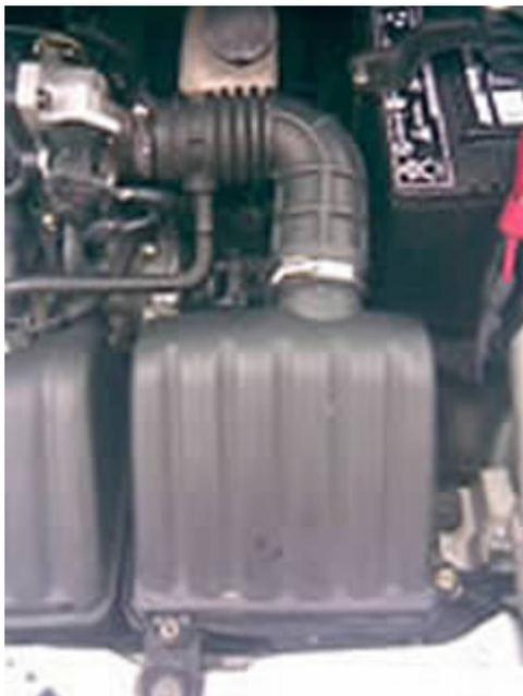
Con el destornillador plano suelta las dos abrazaderas de la manguera:
