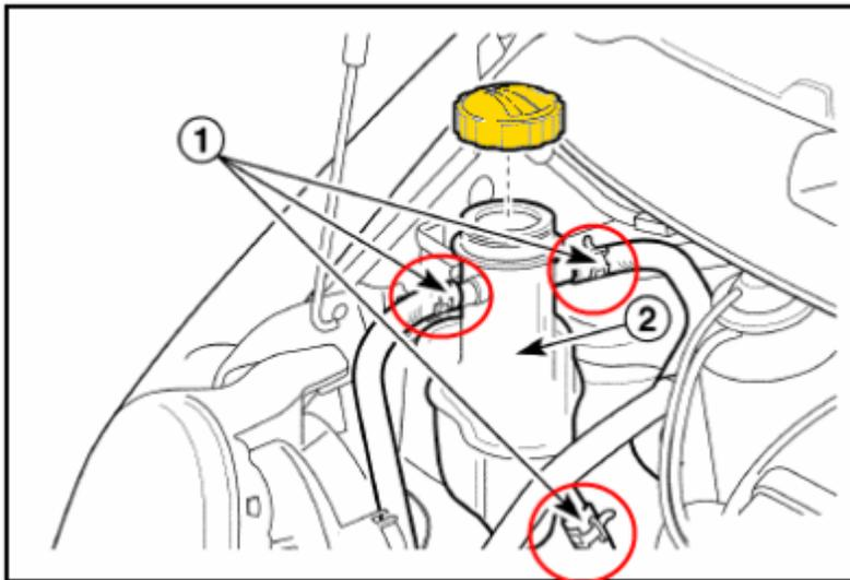
El tanque de refrigerante se encuentra sometido a alta presión de gas refrigerante cuando el motor ha alcanzado su temperatura de operación normal.
