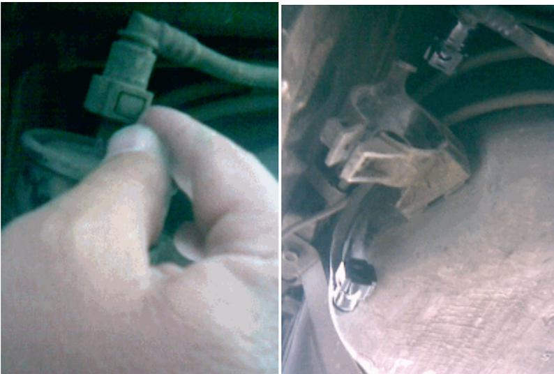
Luego se instala el filtro de gasolina nuevo, se lo asegura con el tornillo autoroscante que lo sostiene, se conecta el cable de tierra y se conectan las dos mangueras de combustible, asegurándose que al ingresar hagan un click, esto nos avisa que están correctamente puestas y que no se saldrán al momento de tener presión de combustible.
