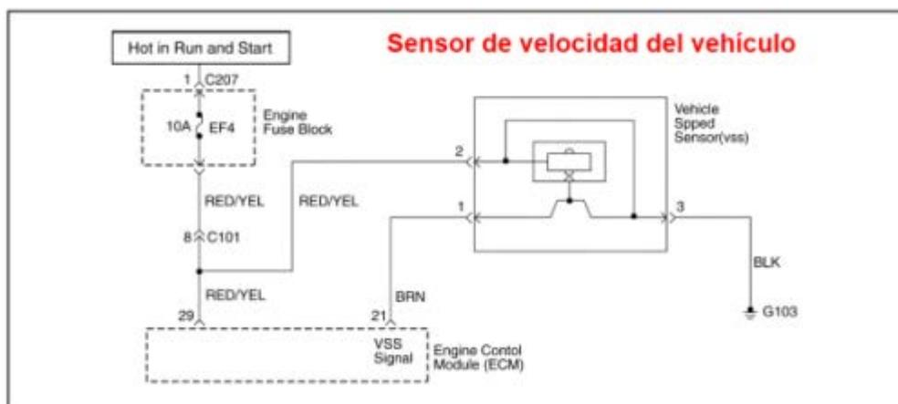
Como se observa del circuito anterior existe el fusible de 10A (de color rojo), ver [Caja de fusible del motor](#), EF4 (Engine Fuse Block), que alimenta varios circuitos entre ellos el del velocímetro. Este sensor termina dañándose cuando la bobina (terminales 2 y 3) se abre.
