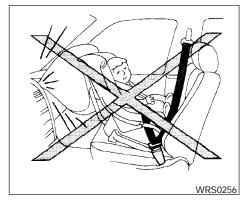
CHILD RESTRAINT INSTALLATION ON FRONT PASSENGER SEAT
