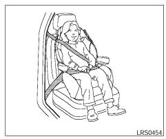
**BOOSTER SEAT INSTALLATION ON** FRONT PASSENGER SEAT
