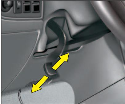
El volante puede ser regulado en altura y en profundidad.
