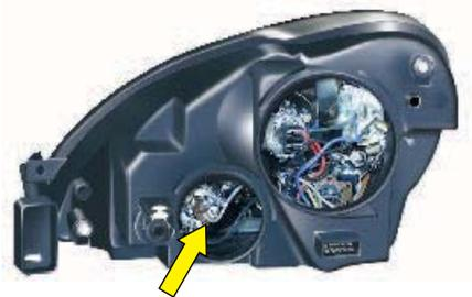
**Alumbrado de carretera****Lámpara:** H1 (55W)
