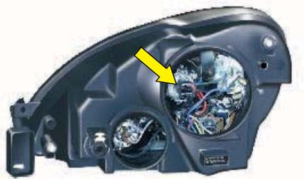
**Bloque óptico delantero****Alumbrado de cruce****Lámpara:** H7 (55W)
