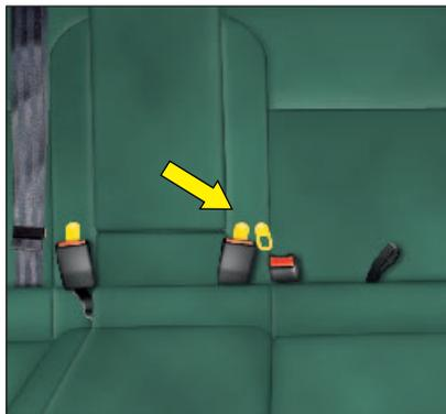
Fijar las hebillas de los cinturones sobre las patillas existentes para ello.
