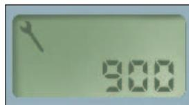
A los cinco segundos de poner el contacto, el totalizador kilométrico prosigue su funcionamiento normal y **el símbolo de mantenimiento permanece encendido.**
