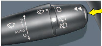
Para obtener la selección de las diferentes informaciones y su visualización, efectuar breves impulsos sobre el extremo del mando limpiaparabrisas delantero.
