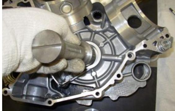
Durante el montaje, alinear la muesca del punzón con la canalización del aceite de lubricación de los bujes.
