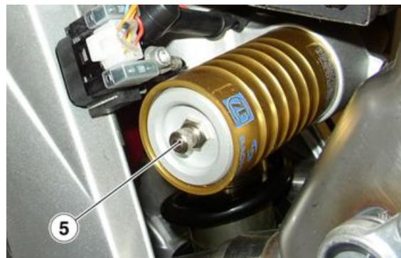
El vehículo puede ser equipado con dos amortiguadores diferentes. Para identificarlos, se debe controlar el valor del "K" del muelle, marcado con una etiqueta en las espiras del mismo.
