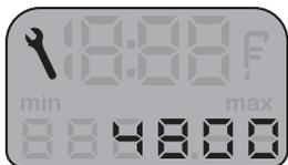
5 segundos depois da ligação da chave, o conta-quilómetros passa ao funcionamento normal e o visor indica a quilometragem total ou diária.
