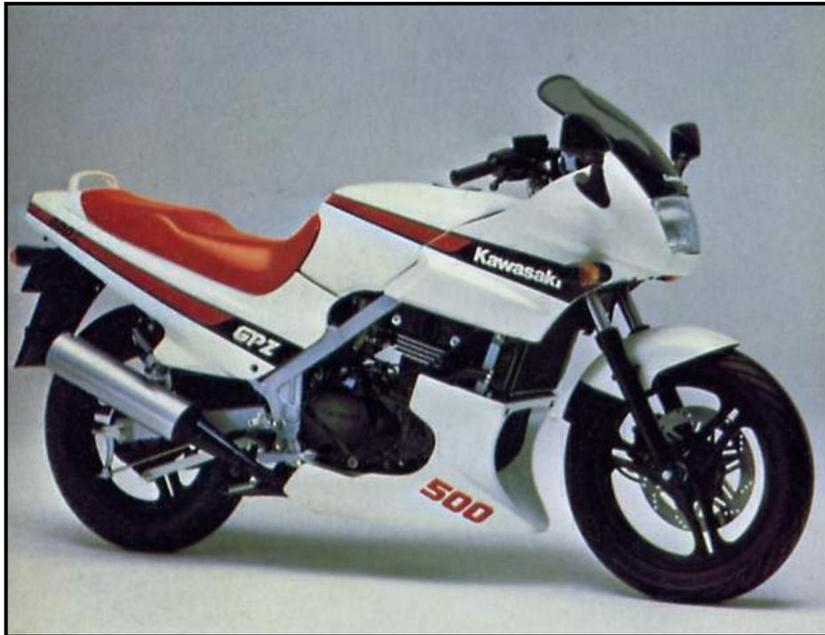
LA PRIMERA VERSIÓN DE LA GPZ 500 S. LA RUEDA DELANTERA VIENE EQUIPADA CON SOLO UN DISCO DE FRENO.
