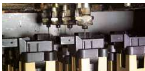
El cable secundario está incrustado en la resina de relleno mediante relleno al vacío.
