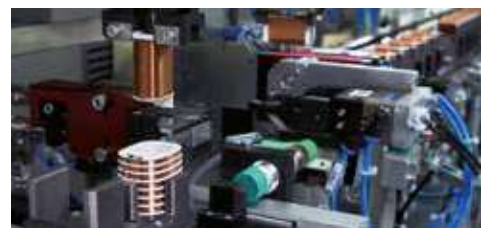
Aquí las bobinas primarias y secundarias ya se han montado por completo automáticamente.
