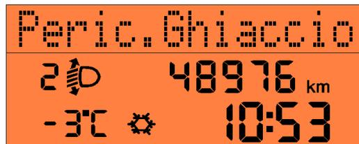
**El cluster (solo Comfort) recibe vía B-CAN del Body Computer la temperatura exterior y visualiza los grados en el display.**
