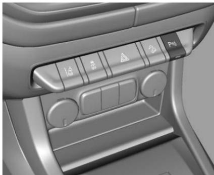
El botón **P** del tablero de instrumentos se usa para activar o desactivar la Asistencia de estacionamiento delantera o trasera. El indicador LED al lado del botón se enciende cuando las funciones no están activadas y se apaga cuando se han deshabilitado.
