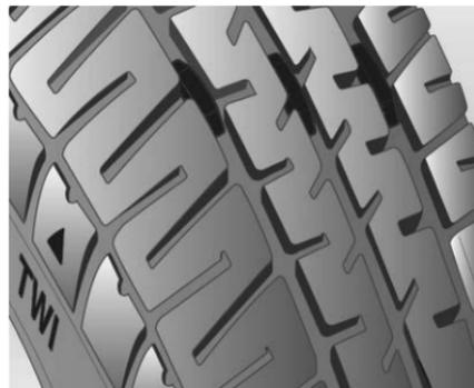
Los neumáticos se deben reemplazar también cuando la profundidad de la rodada se desgaste cerca de 3 mm. La imagen muestra dónde se puede encontrar la profundidad de la rodada.
