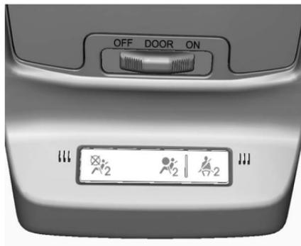
Cuando se enciende el vehículo, los símbolos del indicador de estado de la bolsa de aire del pasajero para encendido y apagado, se iluminarán por varios segundos como parte de una verificación del sistema. Entonces, después de varios segundos, ya sea el símbolo de encendido o de apagado se iluminará para informarle el estado de la bolsa de aire delantera exterior del pasajero.
