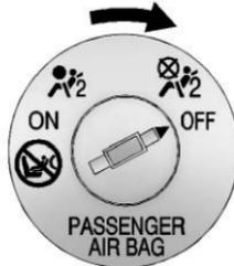
Para desactivar la bolsa de aire del pasajero del asiento delantero, inserte la llave de ignición en el interruptor, oprímala hacia dentro y mueva el interruptor hasta la posición de DESACTIVADO. La bolsa de aire del pasajero delantero está desactivada y no se inflará en caso de una colisión.
