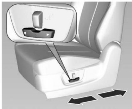
La posición se puede ajustar moviendo el interruptor hacia adelante o hacia atrás.
