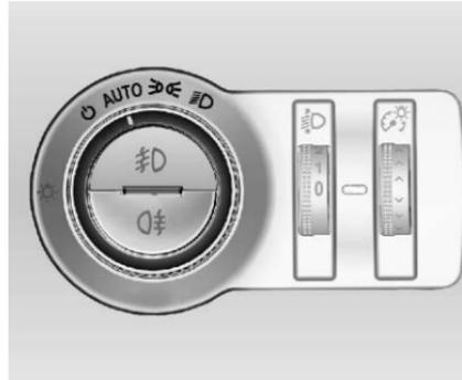
Cuando la función automática de la luz **AUTO** está encendida, el sistema enciende las luces delanteras y traseras de forma automática, dependiendo de las condiciones de iluminación exterior.
