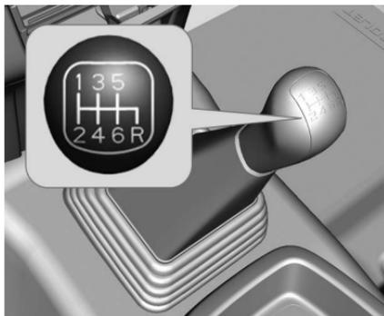
Reversa: con el vehículo estacionario, presione el pedal del embrague.
