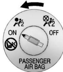
Para activar nuevamente la bolsa de aire del pasajero del asiento delantero, inserte la llave de ignición en el interruptor, oprímala hacia dentro y mueva el interruptor hasta la posición de ACTIVADO.
