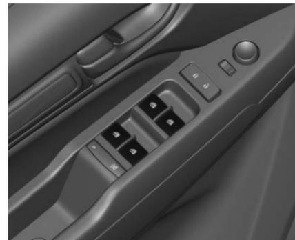
Accione el interruptor para cada ventana respectiva oprimiendo o jalando para cerrar. El interruptor para la ventana del conductor cuenta con una luz la cual indica, al iluminarse, que está lista para funcionar.
