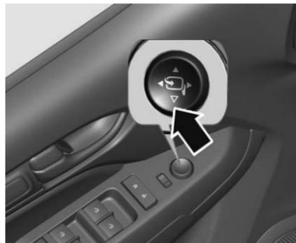
Oprima el interruptor selector (interruptor L / R) hasta la posición central, • a continuación oprima el interruptor de cuatro vías. Ambos espejos exteriores se plegarán.
