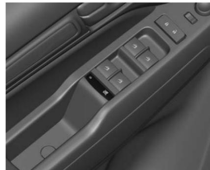
Oprima el interruptor
