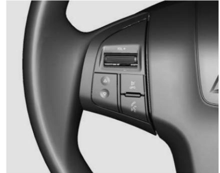
El sistema de infoentretenimiento se puede operar por medio de los controles del volante.
