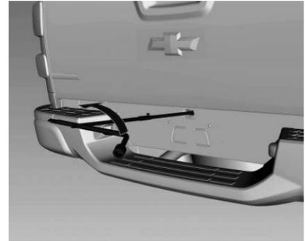
3. Haga girar la llave para las ruedas en sentido inverso al de las manecillas del reloj para bajar la llanta de refacción al suelo. Continúe girando la llave para las ruedas hasta que la llanta de refacción pueda sacarse de debajo del vehículo.
