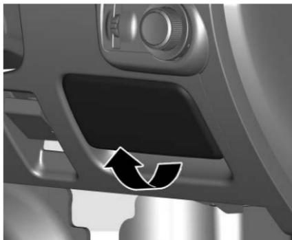
Remueva la tapa del tablero de instrumentos en la dirección de la flecha.
