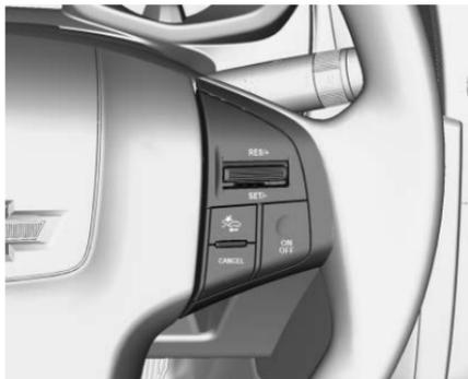
El Control de velocidad constante y la Alerta de colisión frontal se pueden operar por medio de los controles del volante.
