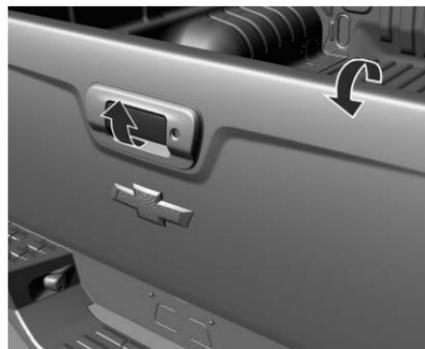
Para abrirla, jale la manija central y baje la puerta trasera. Para cerrarla, levante la puerta trasera y presione sobre los extremos superiores hasta oír un ruido de bloqueo.
