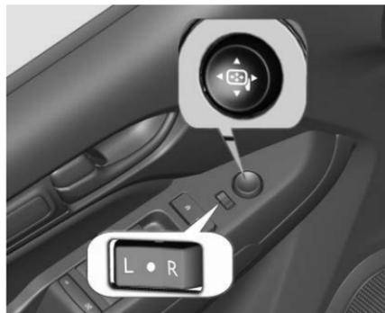
El control de los espejos eléctricos está situado en la puerta del conductor.
