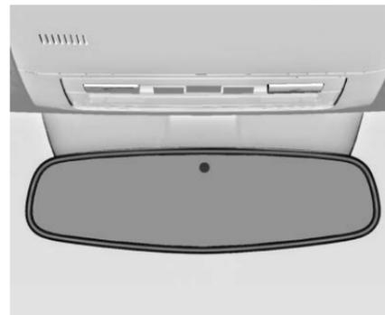
El deslumbramiento de vehículos que vienen siguiendo en la noche se reduce automáticamente.
