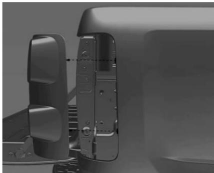
2. Retire el ensamblaje de la luz trasera jalándolo hacia fuera de la carrocería. Tenga cuidado de que el ducto del cable se mantenga en su posición.
