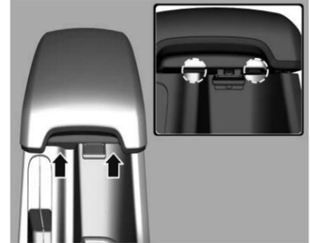
El reposabrazos tiene una ruta para el cable auxiliar.
