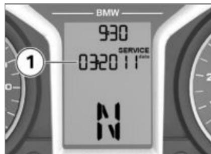
Si el tiempo restante hasta el siguiente servicio de mantenimiento es inferior a un mes, la fecha del servicio de mantenimiento **1** se mostrará brevemente a continuación del pre-ride check. El mes y año se representan con dos y cuatro cifras respectivamente separados con dos puntos. En este ejemplo, la indicación significa "marzo 2011".
