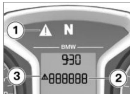
Las advertencias que no disponen de un testigo de aviso propio se representan mediante el testigo de aviso general **1** junto con una indicación de advertencia o un símbolo de advertencia en la pantalla multifunción. En función de la urgencia de la advertencia,
