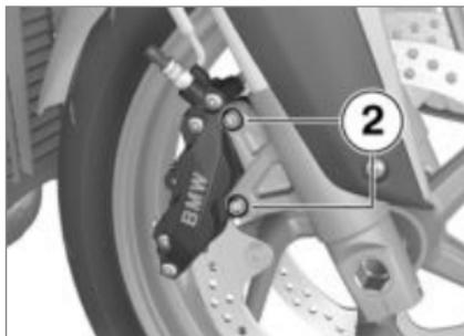
**!** Una vez desmontadas las pastillas de freno, estas pueden presionarse hasta el punto que al efectuar el montaje no puedan encajarse en el disco de freno.
