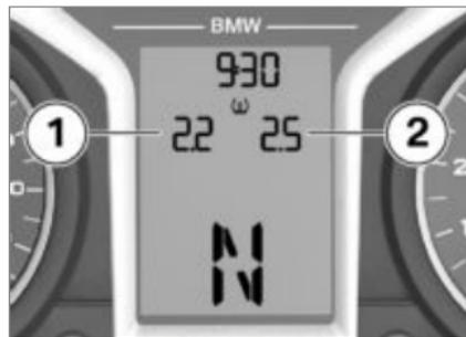
La presión de inflado de los neumáticos indicada hace referencia a una temperatura de los neumáticos de 20 °C. El valor de la izquierda **1** representa la presión de inflado de la rueda delantera, y el de la derecha **2**, el de la rueda trasera. Inmediatamente después de conectar el encendido aparece -- --, ya que la transmisión de los valores
