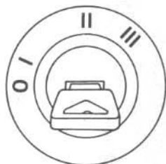
Combiné antivol - contact - démarreur. (Photo R.T.A)
