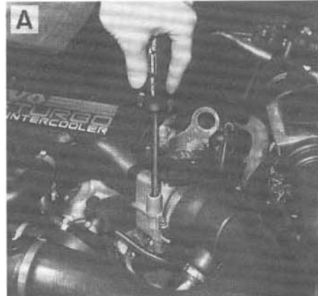
Réglage de base du papillon 1. Cavalier de blocage - 2. Vis de réglage - 3. Levier de commande du papillon.
