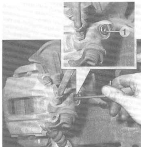
Désarmement du frein de stationnement 1. Bouchon vissé.
