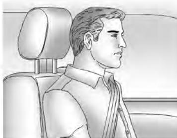
Ajuste el apoyacabezas de modo tal que su parte superior esté a la misma altura que la parte superior de la cabeza del ocupante. Esta posición reduce las probabilidades de una lesión de cuello en un choque.
