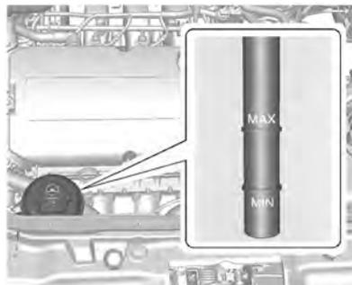
Cuando el motor está caliente, el nivel debe estar en el nivel de temperatura MAX. Cuando el motor está frío, el nivel de líquido deberá estar entre MIN y MAX en la varilla de medición.
