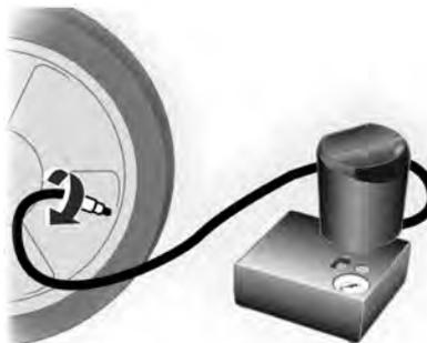
8. Desatornille la tapa de la válvula del neumático defectuoso.
