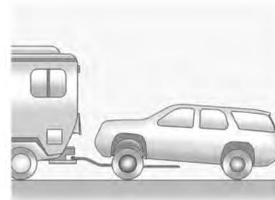
Para remolcar un vehículo con tracción delantera, con dos ruedas en el suelo
