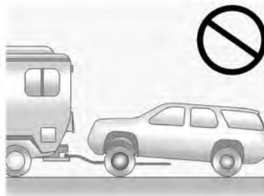
Los vehículos con tracción en las cuatro ruedas no deben ser remolcados con dos ruedas apoyadas en el suelo. Para remolcar correctamente estos vehículos, deben colocarse en un remolque de plataforma, con las cuatro ruedas sin tocar el suelo.
