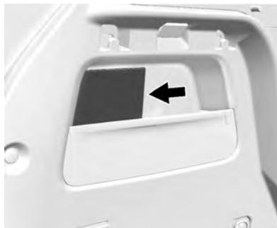
La caja de fusibles del compartimiento trasero está detrás de una tapa, en el lado izquierdo del compartimiento trasero. Para acceder a los fusibles, desmonte la tapa.
