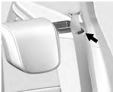
5. Asegúrese de que el cinturón de seguridad pase por el gancho retenedor que se encuentra en la parte superior del respaldo, si está equipado.
