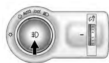
El botón de las luces antiniebla delanteras está en el lateral del tablero de instrumentos.
