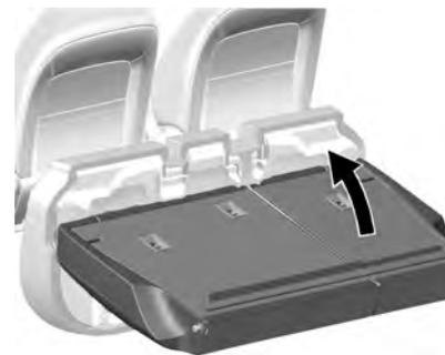
7. Pliegue el respaldo hacia adelante y hacia abajo.
