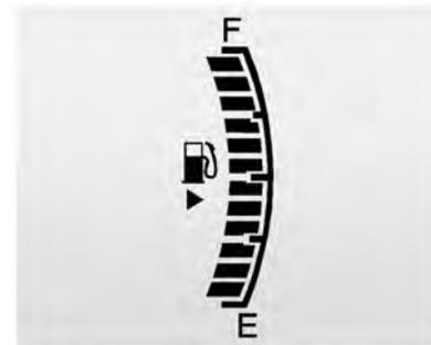
El medidor de combustible indica aproximadamente cuánto combustible hay disponible cuando se coloca el encendido a ON/RUN (ENCENDIDO/MARCHA).
