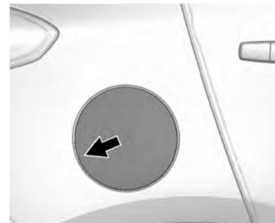
La tapa del combustible está detrás de una puerta con bisagra, del lado trasero derecho del vehículo.
