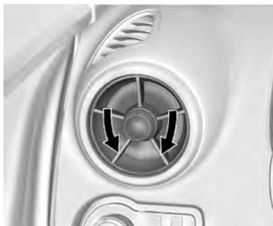
Gire hacia la izquierda o hacia la derecha las perillas de las salidas de ventilación laterales para abrir o cerrar la salida de aire.
