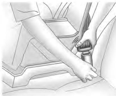
4. Empuje la lengüeta metálica dentro de la hebilla hasta oír un clic.
