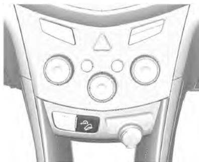
Active el sistema pulsando el botón del DCS en la consola central. La luz verde del DCS se enciende permanentemente en el cuadro de instrumentos cuando el sistema está activado.
