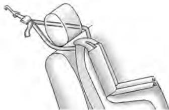
Si la posición que ha escogido tiene un apoyacabezas regulable y está utilizando una correa doble, levante el apoyacabezas y haga pasar la correa por abajo, alrededor de las dos columnas que lo sostienen.
