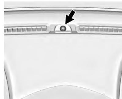
El vehículo tiene un sensor de luz situado en la parte superior del tablero de instrumentos. Asegúrese de no taponarlo, de lo contrario, las luces se encenderán cuando no es necesario.
