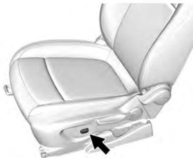
Si está disponible, mantenga pulsada la parte delantera o trasera del interruptor para aumentar o disminuir el apoyo lumbar. Suelte el interruptor una vez que se alcance el nivel de apoyo deseado.
