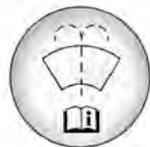
Abra el tapón con que tiene el símbolo del lavaparabrisas. Agregue líquido del lavaparabrisas hasta que se llene el tanque. Vea la ubicación del depósito en *Vista general del compartimiento del motor en la página 10-6.*
