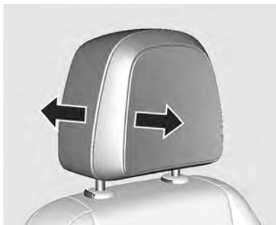
Tire del apoyacabezas hacia adelante. Se puede ajustar en tres posiciones. Para regresarlo hacia atrás, tire del apoyacabezas hacia adelante. De esta forma, se mueve automáticamente hacia atrás.
