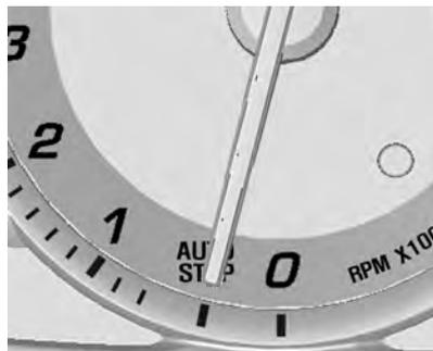
Se indica que el motor está detenido por medio de la aguja apuntando a la posición de AUTOSTOP (DETENIMIENTO AUTOMÁTICO) en el tacómetro.
