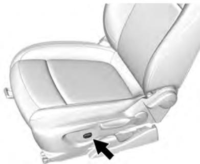
Si está equipado, presione la parte delantera o trasera del interruptor para aumentar o disminuir el apoyo lumbar. Suelte el interruptor cuando alcance el nivel de soporte deseado.
