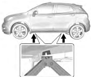
4. Coloque el gato en la posición marcada por un semicírculo.
