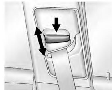
Para bajar la altura del cinturón de hombro, presione el botón de liberación y mueva el ajustador a la posición deseada. Puede levantar la altura del ajustador empujando hacia arriba la guía del cinturón de hombro.
