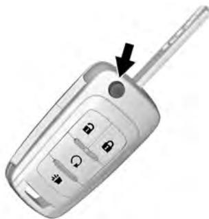
Pulse el botón liberador de la llave para desplegar el vástago. La llave se puede utilizar para el encendido y para todas las cerraduras.
