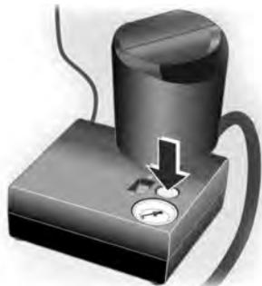
13. La presión necesaria en el neumático (aprox. 2,4 bar) se alcanza en no más de 10 minutos. Una vez alcanzada la presión correcta, apague el compresor.
