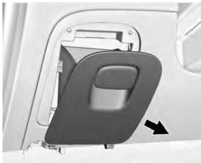
La caja de fusibles del tablero de instrumentos está en la parte inferior del tablero de instrumentos del lado del conductor. Para acceder a los fusibles, desmonte el compartimento portaobjetos. Para desmontar el compartimento portaobjetos, empuje ambos lados y extráigalo.
