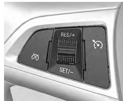
: Pulse para activar y desactivar el sistema de control de cruceo.
