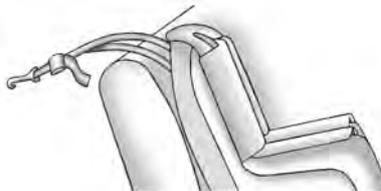
Si la posición que está usando no tiene apoyacabezas y está usando una correa doble, pase la correa por encima del respaldo.
