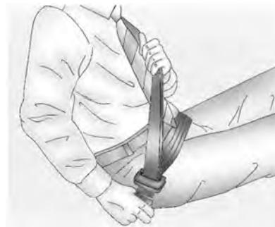
6. Para tensar la parte de la cintura, tire hacia arriba del cinturón de hombro.
