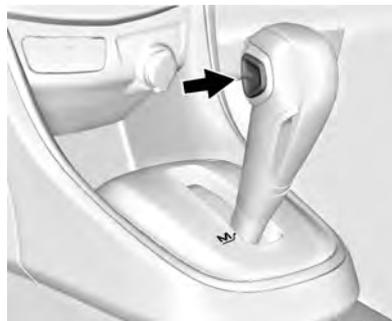
El DSC le permite hacer cambios en una transmisión automática de manera similar a una transmisión manual. Para usar la función de DSC:
