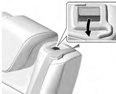
6. Tire de la palanca que se encuentra debajo del cinturón de seguridad, en la parte superior del respaldo, para destrabar el respaldo.
