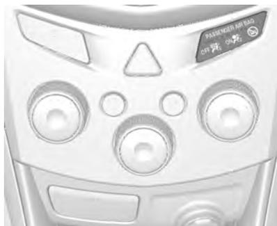
Cuando el vehículo arranca, el indicador y el símbolo ON (ACTIVADO) y OFF (DESACTIVADO) del airbag del acompañante se encenderán por varios segundos, como comprobación del sistema. Luego,
