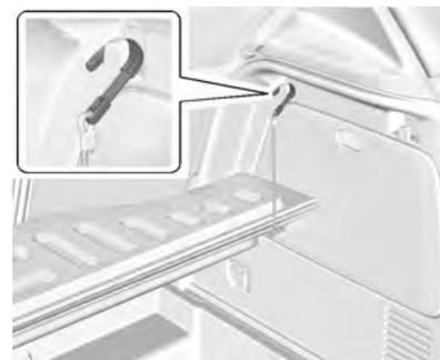
Pliegue el piso de carga. Coloque el gancho del piso de carga en el gancho del panel de revestimiento lateral.
