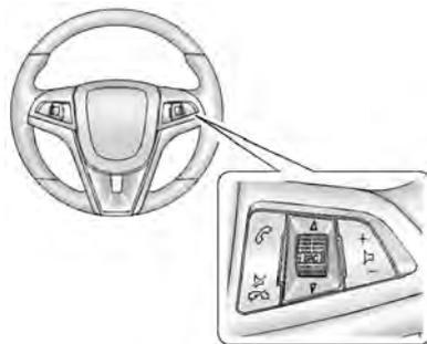
Si está equipado con un sistema de teléfono de manos libres, use un teléfono con Bluetooth y con perfil de manos libres para realizar y recibir llamadas telefónicas. Cuando entra una llamada telefónica, el sistema de infoentretenimiento se interrumpirá y sonará el teléfono, con la llamada entrante en el visualizador. No todos los teléfonos son compatibles con todas las
