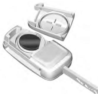
1. Despliegue el vástago de la llave y retire la tapa de la batería en la parte trasera del transmisor haciendo palanca con el dedo.
