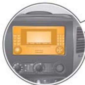
Unidad de control con unidad indicadora para radio y sistema de navegación J503 / radio R, en el centro del tablero de instrumentos
