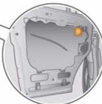
Unidad de control puerta lado conductor J386, en la puerta delantera izquierda
