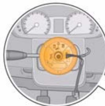
Unidad de control para electrónica de la columna de dirección J527, adosada a la columna de dirección
