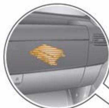
Unidad de control para electrónica de mando del teléfono móvil J412, bajo la guantera
