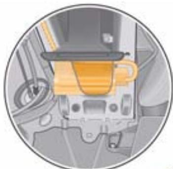
Unidad de control para calefacción adicional J364, en el techo interior del vehículo, cerca del retrovisor interior
