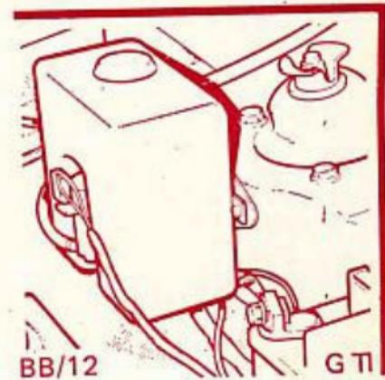
Deberá comprobarse el nivel del refrigerante del radiador cuando el motor esté frío.
