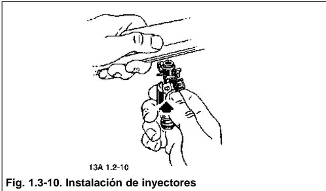
Fig. 1.3-10. Instalación de inyectores
