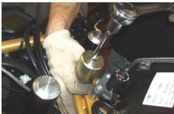
Durante el montaje del perno en U orientar las dos referencias hacia la parte delantera del vehículo.
