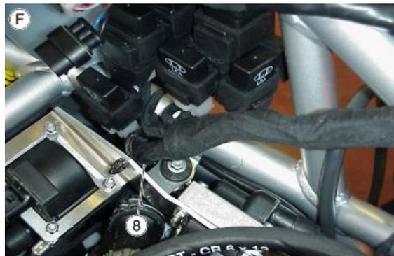
**TABLA G - Posicionamiento inyector cilindro delantero**
