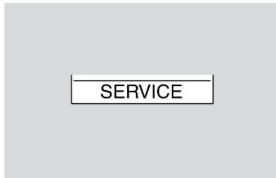
Si durante el encendido se verifica una anomalía en el immobilizer, el tablero solicita que se ingrese el código del usuario. Si se ingresa el código correctamente, el tablero indica la anomalía visualizando el símbolo SERVICE y encendiendo el testigo rojo de alarma general.
