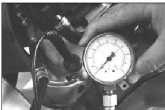
**5** - Medir la presión con motor frío y en ralentí.
