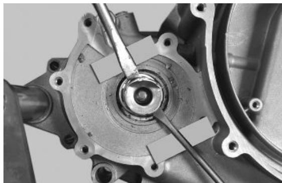
Durante el desmontaje de la junta, es posible que se quiebre la junta cerámica.
