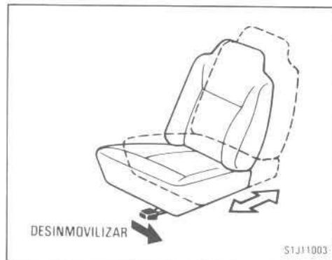
Tire de la palanca de desinmovilización lateralmente. Luego deslice el asiento hasta la posición deseada, presionando ligeramente con el cuerpo, y suelte la palanca.
