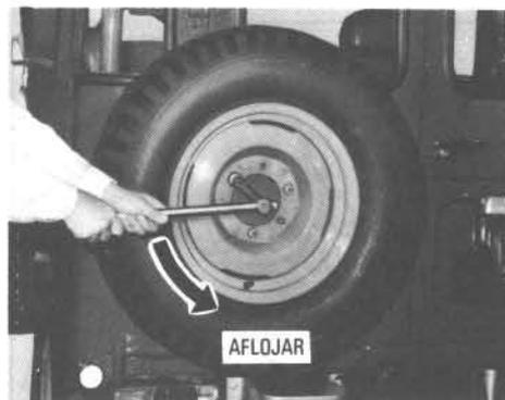
**2. CAPOTA DURA Y CAPOTA BLANDA:** En la parte de atrás del vehículo, saque las tres tuercas de sujeción y saque, levantándolo, el neumático de repuesto.
