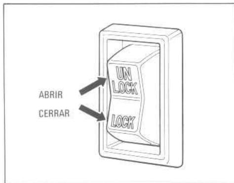
Para cerrar el portón trasero, empuje el interruptor en el lado "LOCK" (cerrar). Para abrir el portón trasero, empuje el interruptor en el lado "UNLOCK" (abrir).
