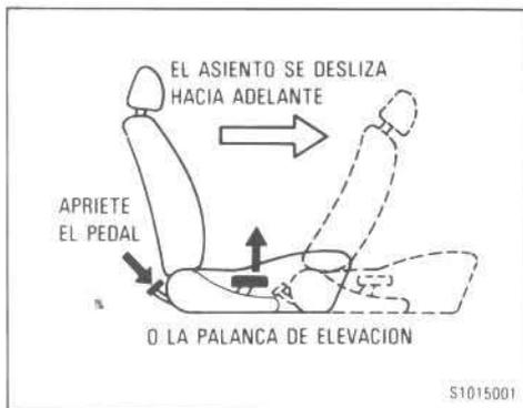
**Tire de la palanca de desinmovilización del respaldo hacia arriba o apriete el pedal de suelta—el asiento del pasajero se desinmovilizará automáticamente hacia adelante.**
