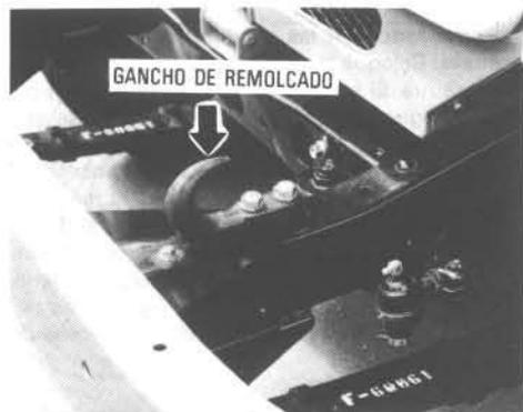
**Para un remolcado de emergencia, asegure un cable al gancho de remolcado de la parte delantera del bastidor.**
