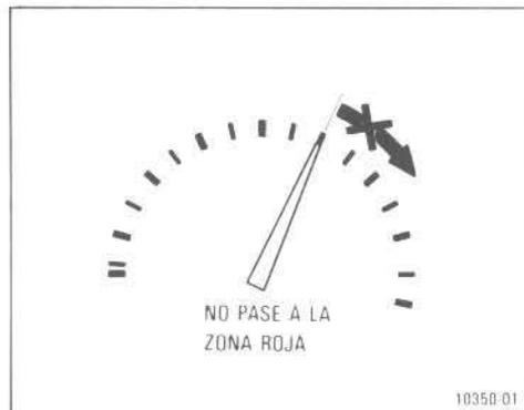
El tacómetro indica la velocidad del motor en miles de rpm (revoluciones por minuto). Uselo mientras maneja para seleccionar los puntos de cambio correctos y para evitar el arrastre y la sobreaceleración del motor.
