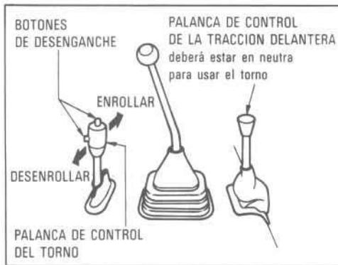
Para controlar el torno, use la palanca de control de la tracción delantera, la palanca de control del torno, el cambio de engranajes y el motor.
