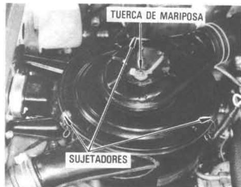
**2. Para inspeccionar el elemento, desenrosque la tuerca de mariposa y suelte los sujetadores. Luego quite la cubierta y saque el elemento tirando hacia arriba.**
