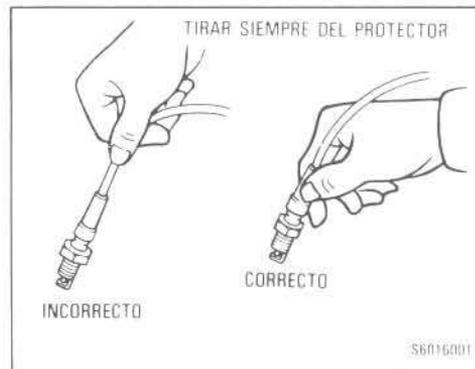
**1. Desenganche los cables de las bujías de encendido tirando de los guardapolvos, no del cable mismo.**
