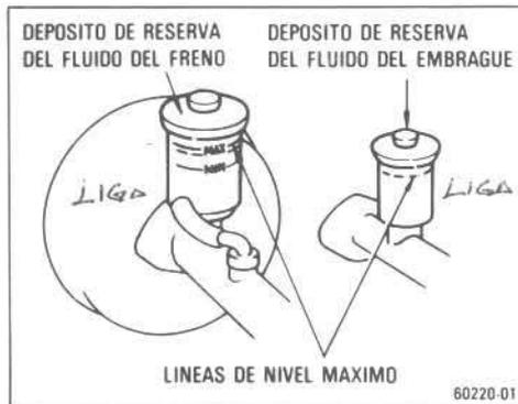
Para comprobar los niveles del fluido, basta con mirar a través de los depósitos de reserva translúcidos. El nivel deberá estar dentro de 10 mm. (0,4") por debajo de las líneas de nivel máximo.
