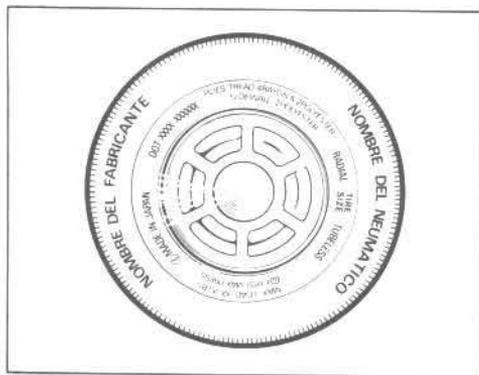
**Cuando cambie un neumático, use solamente el mismo tamaño y construcción que el instalado originalmente y con una capacidad de carga igual o mayor.**
