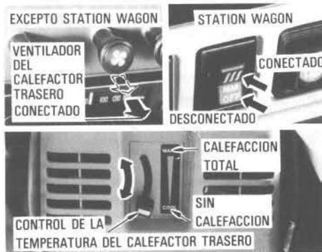
**Conecte el ventilador y ajuste el control de la temperatura a la más adecuada.**
