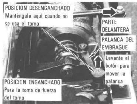
Primero, confirme que la palanca del embrague del torno está en la posición de desenganchado. Luego saque el cable tirando con la mano. Para accionar el torno, coloque la palanca en la posición de enganchado.
