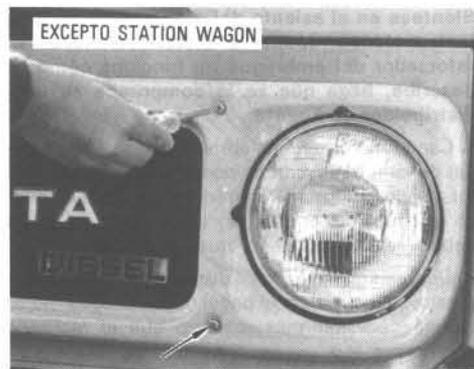
**1. EXCEPTO STATION WAGON:** Afloje los tornillos de retén de la rejilla del radiador.
