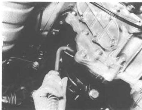
Si el nivel está bajo, añada aceite de engranajes de objetivo múltiple (API GL-4 o GL-5) hasta que comience a salirse por el orificio de admisión. Vuelva a instalar firmemente el tapón.
