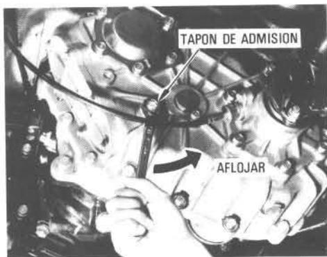
Saque el tapón de admisión y meta el dedo en el orificio. El aceite deberá llegar al borde inferior del orificio. Si el nivel es correcto, vuelva a instalar el tapón y apriételo.
