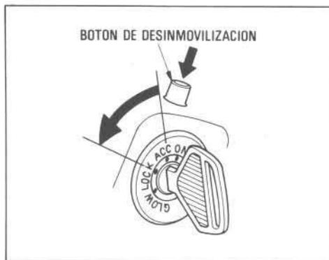
**"LOCK" (inmovilización) (Con seguro de la dirección)**—El volante de dirección está inmovilizado. La llave se puede sacar solamente en esta posición.
