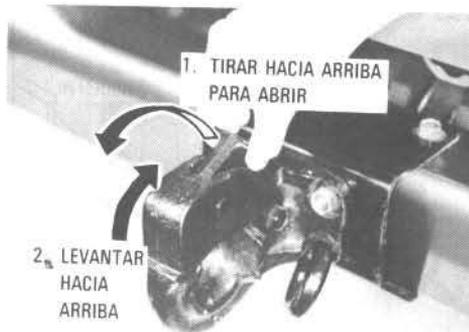
**Tire hacia arriba de la palanca de inmovilización de gancho de tracción y levante la mitad superior del gancho. Después de enganchar, deje que la mitad superior baje de nuevo.**
