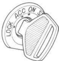
**“ON” (conexión)**—Para conectar las bujías incandescentes y precalentar el motor antes de ponerlo en marcha. Después de que arranque, la llave volverá a esta posición y se pueden accionar todos los accesorios.
