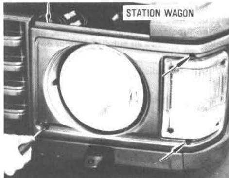
**STATION WAGON:** Abra el capó del motor y afloje los tornillos de retén del ornamento del faro.
