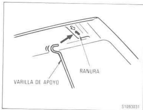
**Después de levantar el capó, manténgalo abierto insertando la varilla de apoyo en la ranura.**
