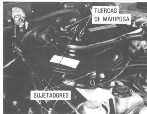
**1. Para inspeccionar el elemento, desenrosque las tuercas de mariposa y suelte los sujetadores. Luego quite la cubierta y saque los elementos tirando hacia arriba.**
