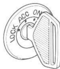
**“ACC” (accesorios)**—El motor está desconectado, pero los accesorios tales como la radio pueden funcionar.
