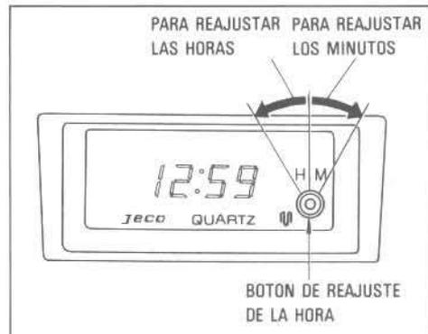
El reloj digital indica la hora cuando la llave de encendido está en la posición "ON" o en la "ACC".
