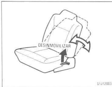
**Echese hacia adelante y tire de la palanca de desinmovilización. Luego échese hacia atrás hasta el ángulo deseado y suelte la palanca.**
