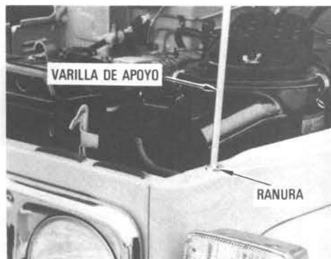
Después de haber subido el capó, manténgalo abierto usando la varilla de apoyo. Inserte el extremo de la varilla en la ranura que hay en el panel lateral del capó.
