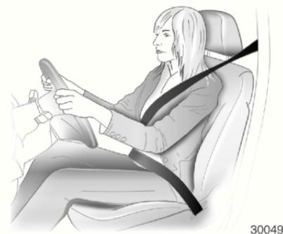
Tire del cinturón de seguridad e insértelo en la hebilla. El cinturón no debe estar torcido y debe usarse muy ajustado y apegado al cuerpo. El respaldo no debe estar reclinado excesivamente. Para soltar el cinturón de seguridad, presione el botón rojo en la hebilla.
