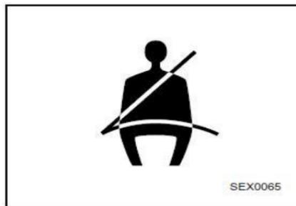
Cuando la llave de contacto está encendida, la luz de aviso del cinturón de seguridad se encenderá brevemente. Esto quiere decir que el sistema está realizando una prueba automática. De ahí en más, a menos que el conductor se haya abrochado el cinturón de seguridad, ocurrirá lo siguiente:
