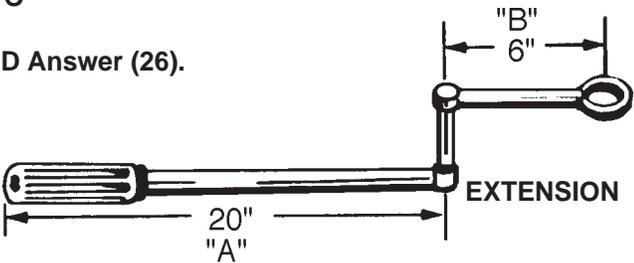
TORQUE WRENCH AND ADAPTER MUST BE USED ONLY IN A STRAIGHT LINE.
