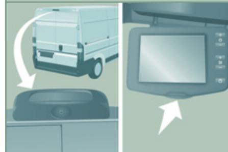
La cámara se enciende al introducir la marcha atrás y permanece activa hasta alcanzar una velocidad aproximada de 15 km/h. Se desactiva al superar los 18 km/h.
