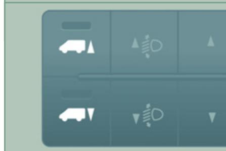
Este equipamiento permite modificar la altura del umbral trasero para facilitar la carga o descarga.
