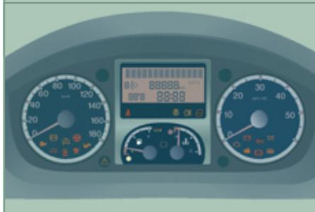
Al poner el contacto, se encienden los testigos de alerta naranjas y rojos. Al arrancar el motor, esos testigos deben apagarse. Si algún testigo permanece encendido, consulte el capítulo correspondiente.
