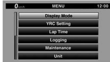
La pantalla MENU (MENÚ) contiene los siguientes módulos de ajuste. Seleccionar un módulo para realizar cambios de configuración relacionados. A pesar de que algunos ajustes se pueden modificar o reajustar a través de la pantalla principal, la pantalla MENU (MENÚ) ofrece acceso a todos los ajustes de visualización y control.
