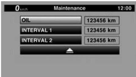
3. Efectúe una pulsación larga sobre el interruptor giratorio para hacer un Reset (Poner a cero) el elemento.
