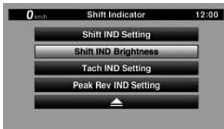
Seleccione “Shift IND Brightness (Brillo INDICADOR Cambio)” y luego utilice el interruptor giratorio para ajustar el brillo. Presione brevemente el interruptor giratorio para confirmar el ajuste y salir.
