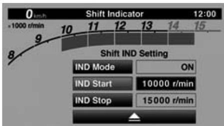
6. Seleccione “IND Stop” (Detención INDICADOR) y luego gire el interruptor giratorio para ajustar las r/min a las que el indicador de punto de cambio
