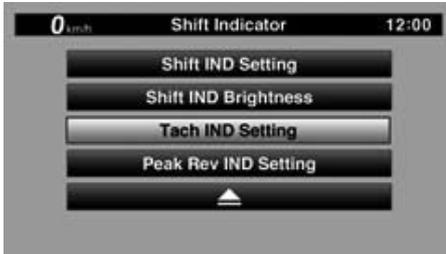
1. Seleccione "Tach IND Setting (Ajuste INDICADOR Tacómetro)".
