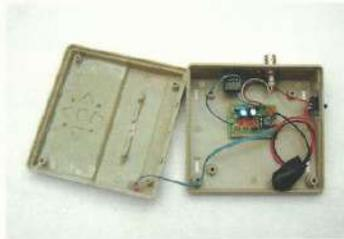
*"Para el montaje en la caja, son necesarios, un conector estero de 3,5mm, un conector BNC para montaje en panel, un interruptor, y un clip de pila de 9v. Recuerden que el Led LD3 (indicador de encendido,) no está incluido en el kit."*
