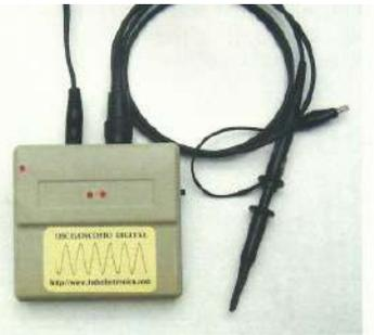
*"Osciloscopio totalmente terminado y listo para su utilización. Recuerden respetar todas las precauciones comentadas en el artículo, para evitar daños a la tarjeta de sonido."*
