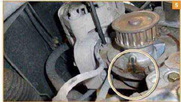
Antes de desmontar la bomba de agua, marca su posición para después colocarla en la misma posición y no afecte en la tensión de la banda de distribución (Fig. 6 y 7).
