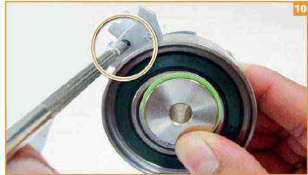
4. Coloca la banda de distribución empezando por el piñón del cigüeñal y después quita el desarmador para tensar la polea, verifica nuevamente las marcas de tiempo (Fig. 2 y 3).
