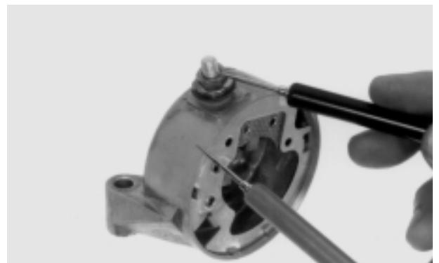
Inspeccione el colector con respecto a daños o a desgaste anormal.
