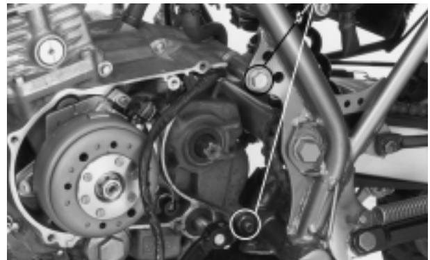
Instale el soporte delantero del motor, tornillos y tuercas.
