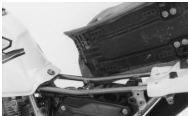
Mida la resistencia entre los alambres azul/amarillo y verde o los bornes de la masa del chasis.
