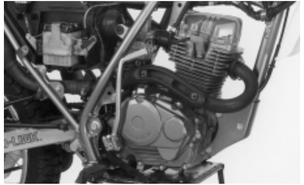
Quite los tornillos, tuercas y separadores del soporte superior del motor.
