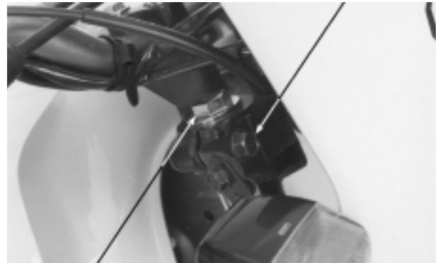
TORNILLO SUPERIOR DEL AMORTIGUADOR
