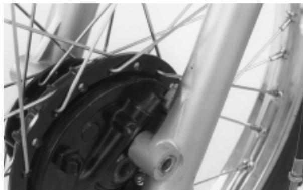
Instale el cable del velocímetro.
