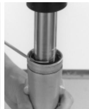
Rellene el amortiguador con fluido ATF o equivalente.
