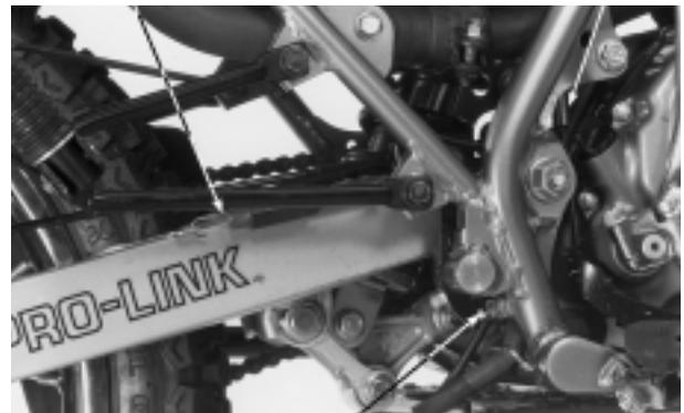
TORNILLO DE SUJECION DEL BRAZO DEL FRENO
