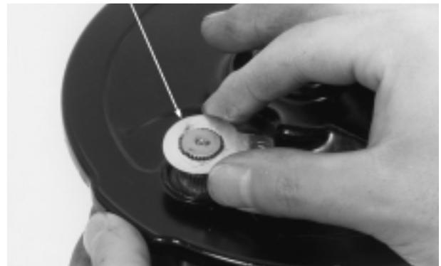
Instale el brazo del freno en la excéntrica, alineando las marcas de referencia.
