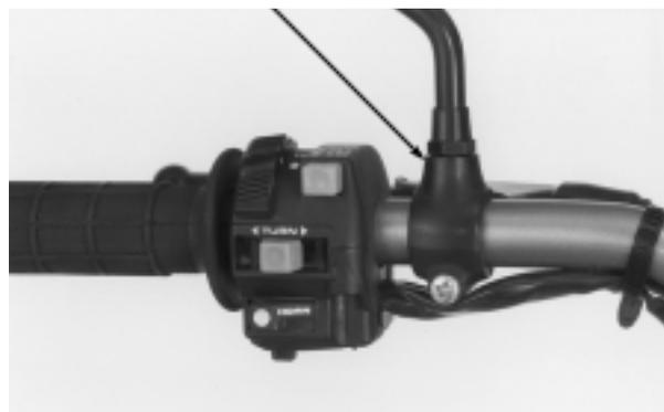
Instale la carcasa del conjunto de interruptores del costado derecho del manubrio, insertando el perno de la carcasa en el agujero del manubrio.
