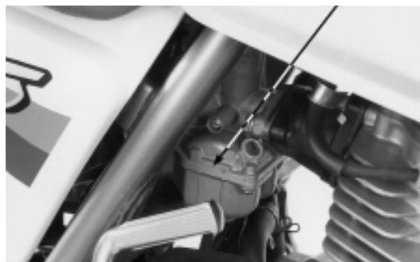
El número de identificación del carburador está grabado en el costado derecho del cuerpo del carburador.
