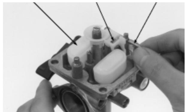
**INSPECCION DEL NIVEL DEL FLOTADOR**
