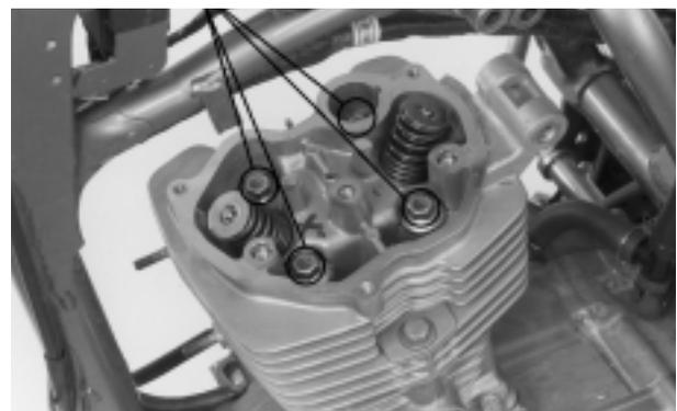
Instale las varillas de las válvulas.
