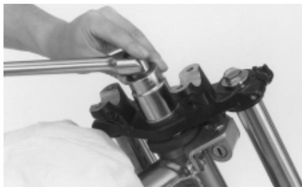
Afloje la tuerca de ajuste de la columna de dirección.
