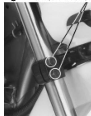
**TORNILLO SUPERIOR DEL AMORTIGUADOR**
