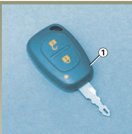
1 Telecomando de bloqueo/desbloqueo de las puertas y del baúl. Llave codificada de contacto-arranque y del tapón de combustible.
