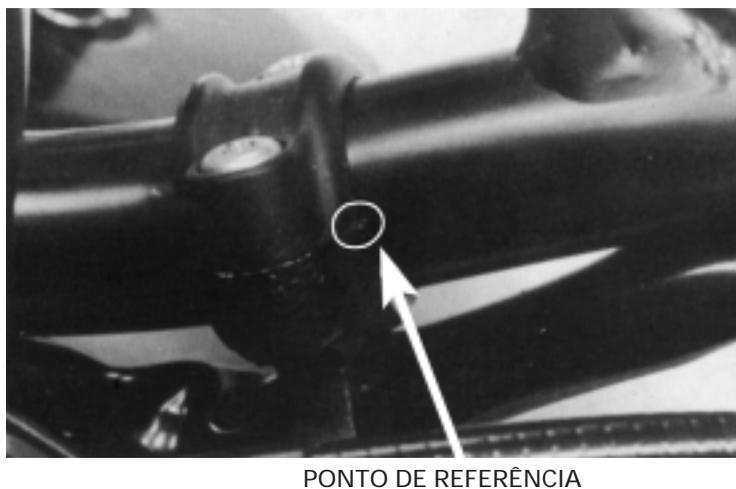
Instale o suporte da alavanca da embreagem, interruptor do motor, interruptor dos equipamentos e suporte da alavanca do freio dianteiro.
