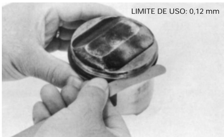
Remova os anéis do pistão. Verifique se o pistão está danificado e o desgaste das canaletas.
