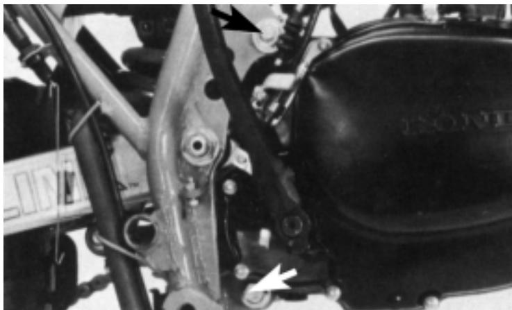
Remova os parafusos superiores de fixação do motor.
