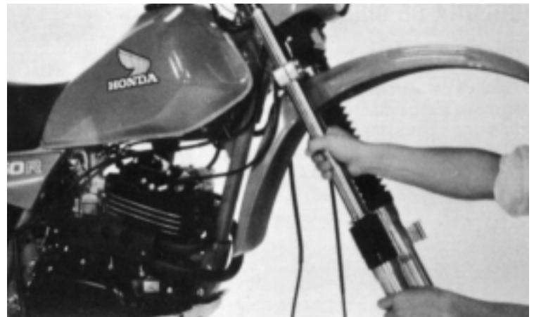
Aperte os parafusos de fixação superiores e inferiores dos amortecedores.
