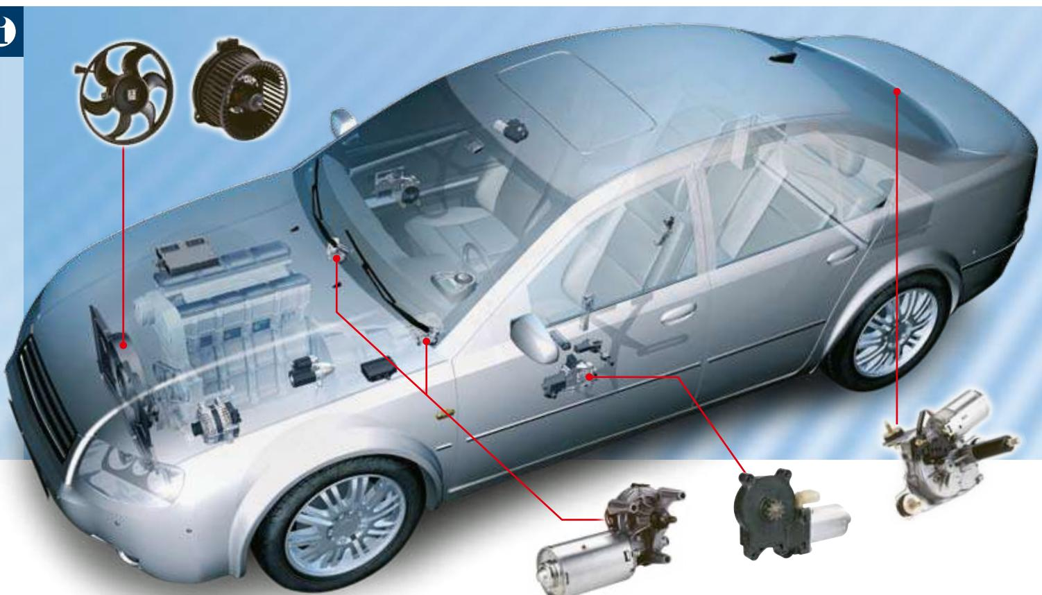
A linha de Motores Elétricos Bosch é responsável pelo acionamento dos limpadores de para-brisa, levantadores de vidro, arrefecimento do motor e ventilação interna que proporcionam ao motorista total conforto e praticidade ao dirigir e trazem mais comodidade para todos os ocupantes do veículo.
