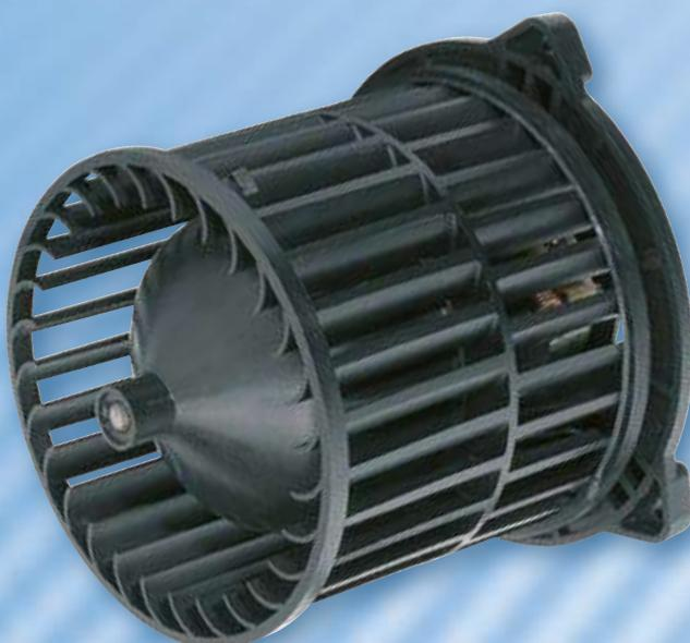
A função do ventilador interno é circular o ar (ambiente ou refrigerado) no interior da cabine do veículo, proporcionando maior conforto e dirigibilidade, uma vez que sua ação permite ainda o desembaçamento dos vidros, garantindo a visibilidade e a segurança do motorista.
