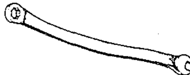
Fre. 279-02 00 00 027 902 Llave de reglaje de los segmentos de frenos
