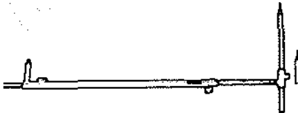
Car. 27 00 01 235 800 Calibre para control del piso y de los órganos mecánicos.
