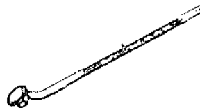
Fre. 374 00 00 037 400 Racor para controlar la estanqueidad de los estribos
