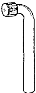
Sus. 545 00 00 054 500 Llave para montar la caja de la barra de torsión delantera
