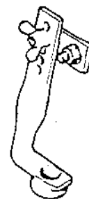
Rou. 541 00 00 054 100 Soportar de comparador para medir el juego de los bujes de ruedas.
