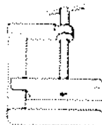
Mot. 453-01 00 00 045 301 Pinzas para apretar tubos flexibles
