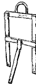
Mot. 488 00 00 048 800 Gancho de levantamiento motor-caja de cambios * vehículos equipados con caja de cambios tipo 354 solamente
