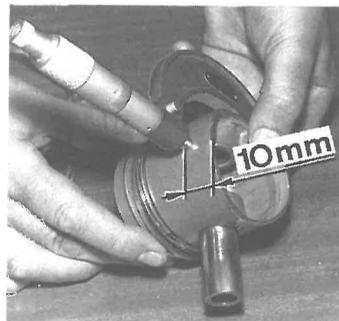
Medición del diámetro de un pistón.
