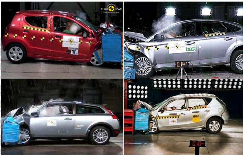
La EuroNCAP realiza pruebas de seguridad pasiva en automóviles nuevos, entregando una clasificación en estrellas basada en el comportamiento del vehículo en pruebas de impacto frontal y lateral. En los últimos años se ha incorporado una prueba de medición de seguridad de niños a bordo, así como de peatones en caso de atropello. Hasta 2009, ambas se medían también con puntos y en estrellas.
