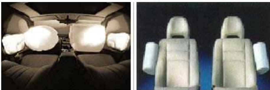
Los airbags laterales son bolsas de aire de alrededor de 12 litros de capacidad que se instalan en los asientos o bien en las puertas del vehículo. Su misión es proteger la cabeza y las caderas del ocupante, evitando el impacto de éste con la estructura de la puerta. Debido al escaso espacio entre el cuerpo del ocupante y la puerta del automóvil, la bolsa se despliega inmediatamente cuando detecta un impacto lateral, tardando alrededor de 3 milisegundos.
