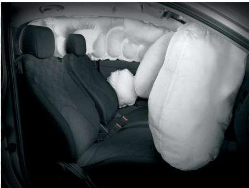
Existen airbags que pueden detectar la posición del conductor frente al volante de dirección, si lleva copiloto, si lleva ajustado el cinturón de seguridad o si en el asiento del copiloto hay instalada una silla para niños. Algunos desarrollos avanzados incluyen un despliegue variable en función del tamaño, peso, posición y cercanía al airbag del conductor, y pueden distinguir la naturaleza del impacto, ya sea frontal, lateral, o vuelco.
