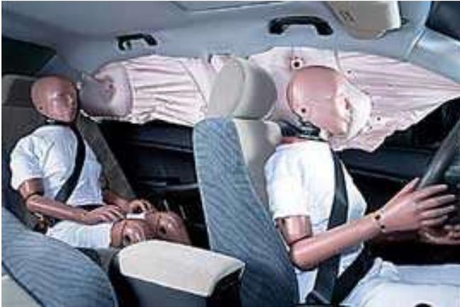
Esta bolsa de aire se ubica en la parte interior del marco del vehículo, recubriendo el lateral a la altura de las ventanillas. En algunos modelos la bolsa es individual y de forma tubular, y en otros es un colchón de mayores dimensiones que protege a todos los ocupantes de un lado. Su tiempo de inflado es de 25 milisegundos.
