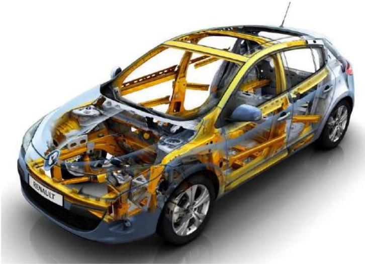
La absorción de parte de la energía del impacto efectuada por las zonas de deformación programada, permite reducir la cantidad de energía que deberá absorber el compartimento de pasajeros, y finalmente los ocupantes. Esto se traduce en pasajeros expuestos a aceleraciones de menores magnitudes, lo cual reduce la gravedad del impacto que “sienten” los pasajeros del vehículo.
