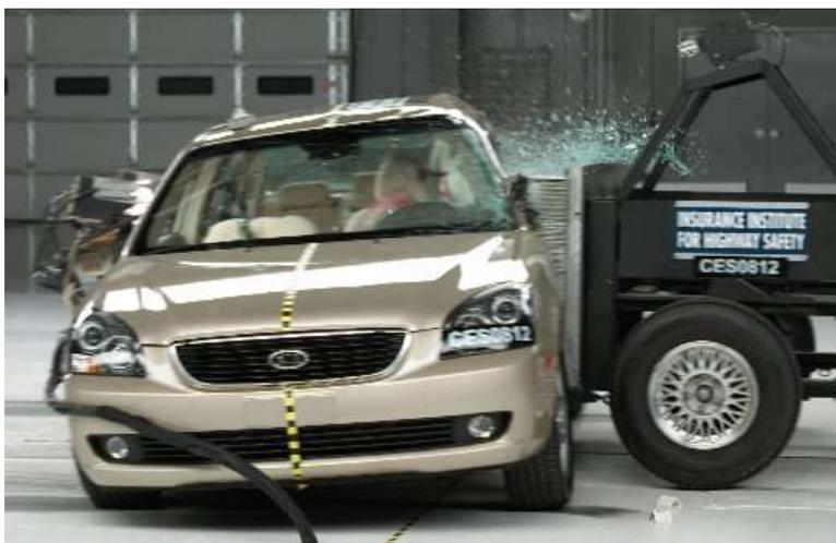
Si se aplica sobre una zona del vehículo virtual una fuerza dada se inicia una reacción en cadena en la que cada área se deforma según los cálculos anteriores y transmite fuerza a las que están en contacto con ella. De esta forma es posible determinar cuál ha sido la deformación total del vehículo completadas con las pruebas reales permiten validar las dimensiones y el comportamiento por separado de ciertos elementos de la carrocería como largueros, travesaños, etc.
