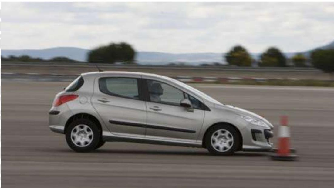
En una frenada de emergencia en un vehículo sin ABS las ruedas se pueden bloquear, si girásemos el volante, como las ruedas no giran, seguiremos la trayectoria que llevamos antes de pisar el freno. Es necesario levantar el pie del freno levemente para combatir la trayectoria si
