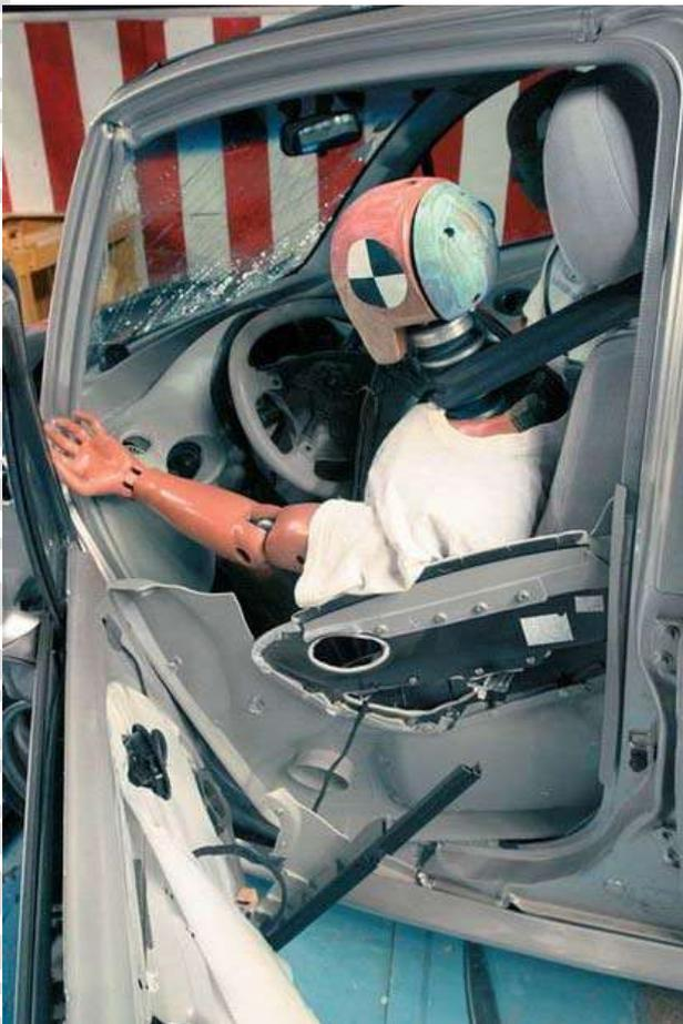
Las zonas de deformación programada se ubican en el sector delantero y trasero del vehículo, y están diseñadas para absorber la mayor cantidad de energía posible en caso de impacto. La absorción de energía se realiza principalmente a través de las deformaciones de piezas
