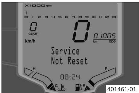
Al conectar el encendido, en el display de información se muestra **Service Not Reset** durante 10 segundos si se ha sobrepasado el kilometraje parcial correspondiente al intervalo de mantenimiento o si la visualización de los intervalos de mantenimiento no se restableció después de un mantenimiento.
