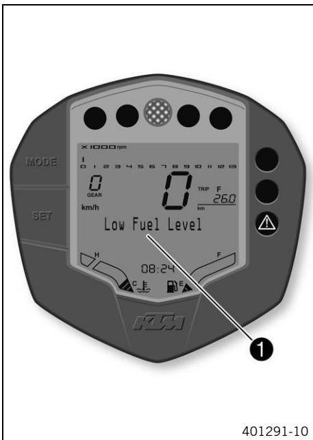
En el display de información ① se visualizan distintas advertencias. Cuando se ilumina el testigo de aviso general ⚠, en el display de información se muestra el aviso correspondiente.
