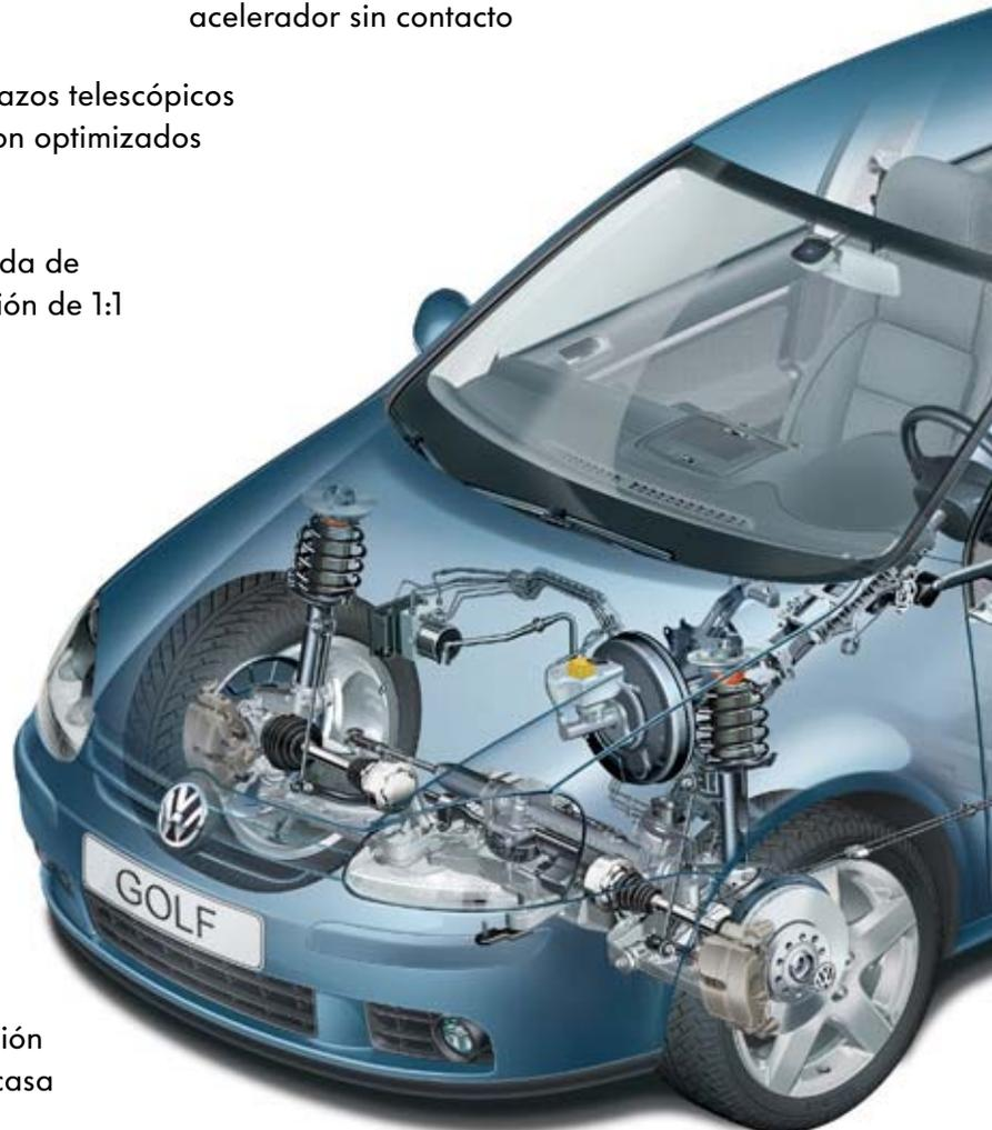
El Golf puede montarse con tres tipos diferentes de tren de rodaje: estándar, deportivo o para firmes en mal estado. Estos trenes de rodaje se diferencian entre sí tanto por los muelles como por los amortiguadores, las barras estabilizadoras y los cojinetes. El tren de rodaje deportivo va 15 mm más bajo que la versión estándar, donde se combina la agilidad con el confort. Con un tren de rodaje para firmes en mal estado, la carrocería va unos 20 mm más alta que con un tren de rodaje estándar.
