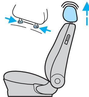
La altura de los apoyacabezas puede ajustarse tirando de ellos hacia arriba o empujándolos hacia abajo.
