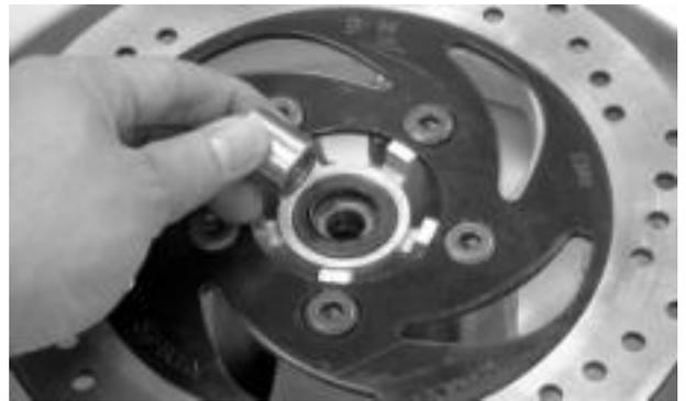
Dé vuelta al alojamiento interior de cada cojinete con su dedo para ver si dan vuelta suavemente. También compruebe si los ajustes externos del cojinete ajustan firmemente en el cubo. Sustituya los cojinetes si no dan vuelta suavemente, o si caben libremente en el cubo.
