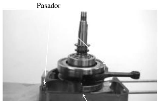
Coloque el cárter del motor derecho sobre el cigüeñal y sobre el cárter del motor izquierdo
