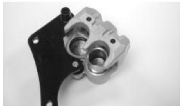
Limpie el líquido de frenos excesivo con una toalla limpia. Aplique la grasa de silicio al perno y al asiento del calibrador del freno. Instale el asiento del calibrador del freno
