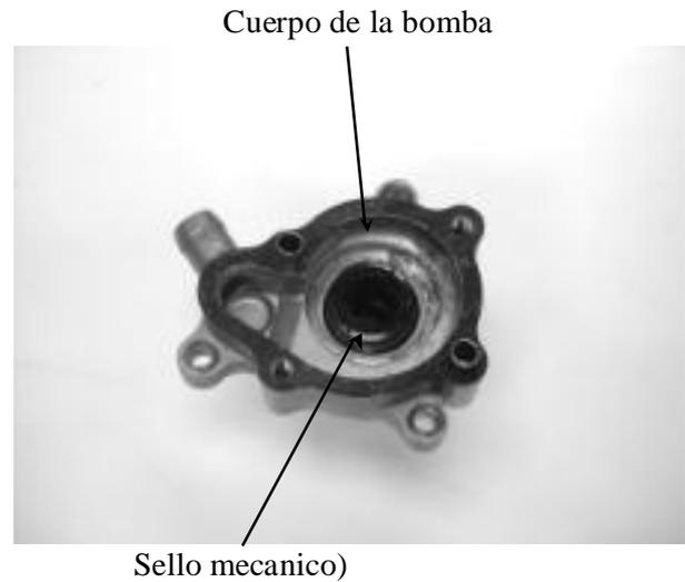
Introduzca un nuevo sello mecánico usando un conductor mecánico del sello
