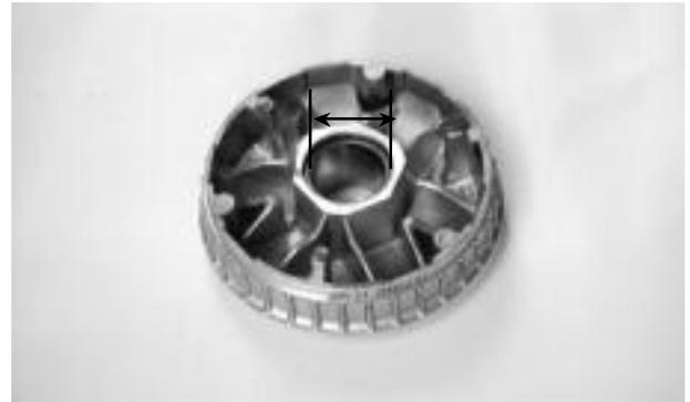
Compruebe el collar de la polea impulsora para saber si hay desgaste o daño.
