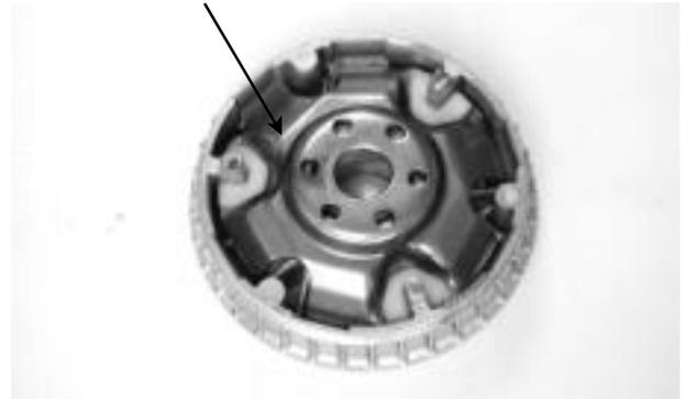
Inserte el collar de la polea impulsora en la cara movable de la impulsión
