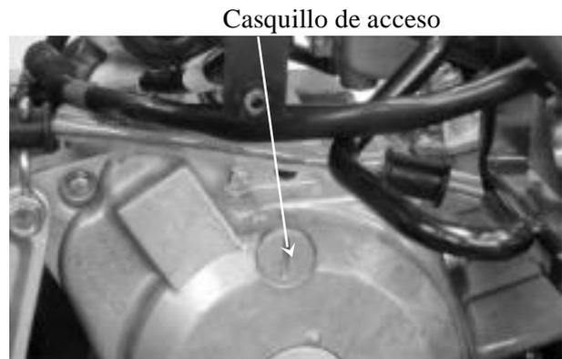
Compruebe la sincronización con una Lámpara de prueba
