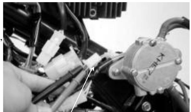
Acoplador de la bobina de pulso
