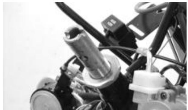
Instale la tuerca de fijacion del vástago, y apriete mientras sujeta la parte superior.
