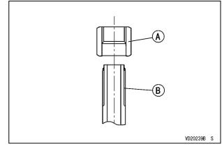
A. Piston Rod Nut B. Piston Rod
