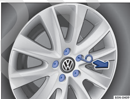
Fig. 270 Retirar las caperuzas de los tornillos de rueda.
