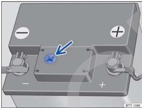
Fig. 259 Mirilla en la parte superior de la batería de 12 voltios (representación esquemática).
