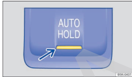
Fig. 157 En la consola central: tecla de la función Auto-Hold.
