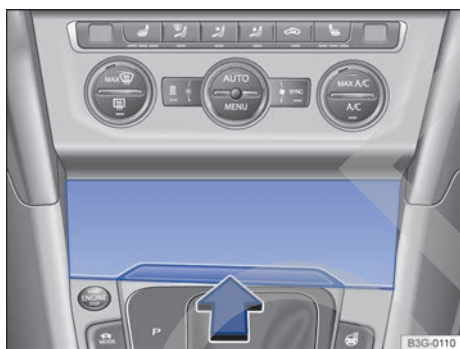
Fig. 177 En la parte delantera de la consola central: abrir el cenicero.
