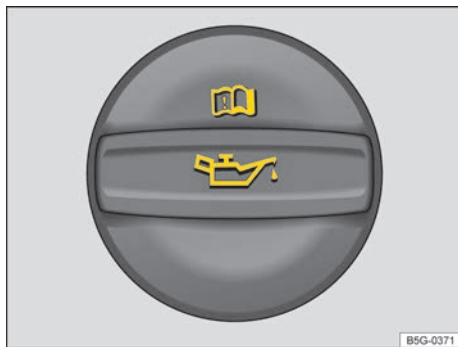
Fig. 254 En el vano motor: tapa de la boca de llenado de aceite del motor (representación esquemática).
