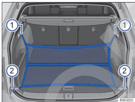
Fig. 207 En el maletero: bolsa de red enganchada delante del umbral de carga.
