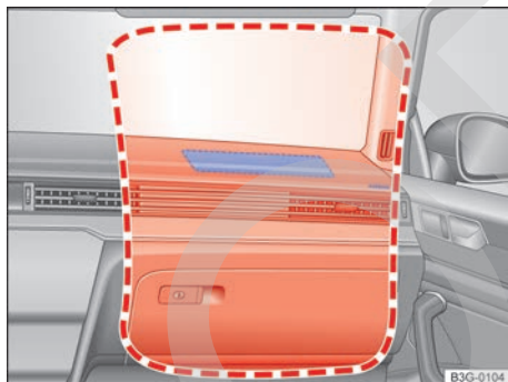
Fig. 48 Ubicación y zona de despliegue del airbag frontal del acompañante.
