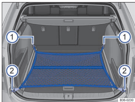
Fig. 206 En el maletero: bolsa de red enganchada a ras del piso.
