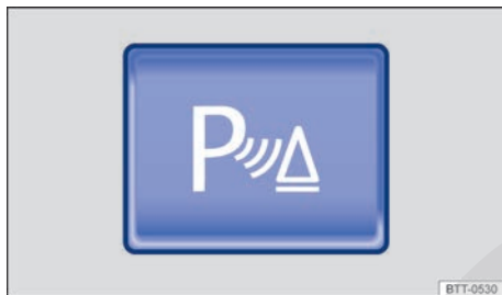
Fig. 158 En la consola central: tecla para conectar y desconectar la ayuda de aparcamiento (en función del equipamiento).
