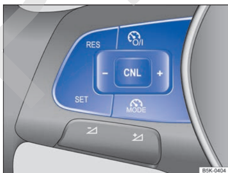
Fig. 146 Lado izquierdo del volante multifunción: teclas para manejar el GRA.
