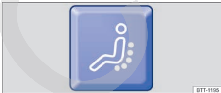
Fig. 104 En la parte inferior del asiento del conductor: tecla de la función de masaje.
