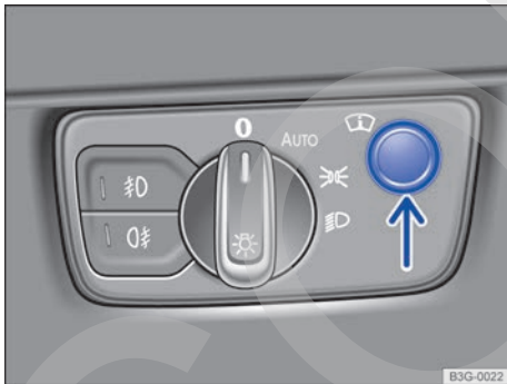
Fig. 18 Junto al volante: regulador del Head-up-Display (flecha).
