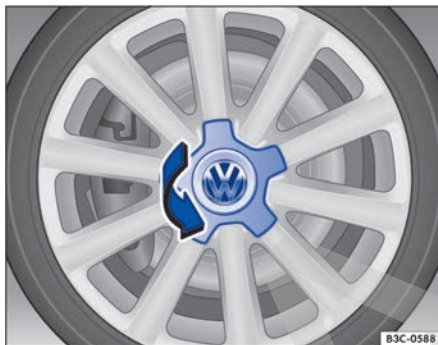
Fig. 268 Desmontar el tapacubos central girándolo.
