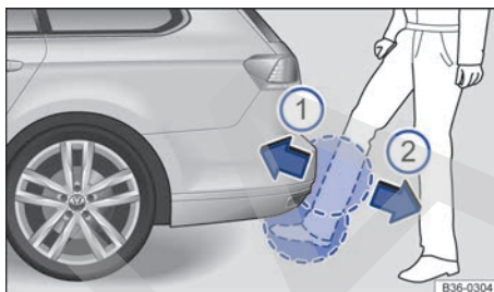
Fig. 83 Portón del maletero con apertura controlada por sensor (Easy Open).
