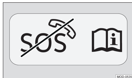
Fig. 185 Adhesivo pegado posteriormente en el vehículo que indica la desactivación permanente de los servicios Car-Net.
