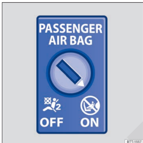
Fig. 49 En el tablero de instrumentos, en el lado del acompañante: conmutador de llave para desactivar y activar el airbag frontal del acompañante.
