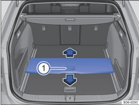
Fig. 193 En el maletero: piso desplazable del maletero.
