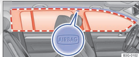
Fig. 53 En el lado izquierdo del vehículo (Variant): ubicación y zona de despliegue del airbag para la cabeza.
