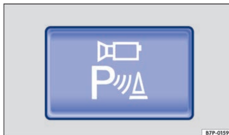
Fig. 167 En la consola central: tecla para conectar manualmente el sistema de visión periférica.
