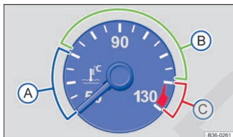
Fig. 24 Indicador de temperatura del líquido refrigerante del motor en el cuadro de instrumentos.
