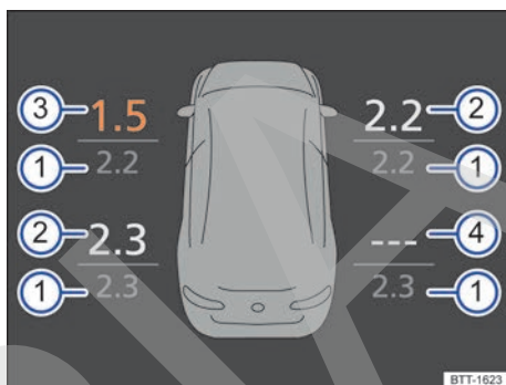
Fig. 260 Representación esquemática de la visualización en la pantalla del cuadro de instrumentos: presiones actuales de los neumáticos.
