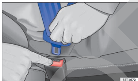
Fig. 42 Soltar la lengüeta del cierre del cinturón.
