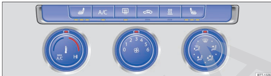
Fig. 121 En la parte superior de la consola central: panel de mandos del climatizador manual.
