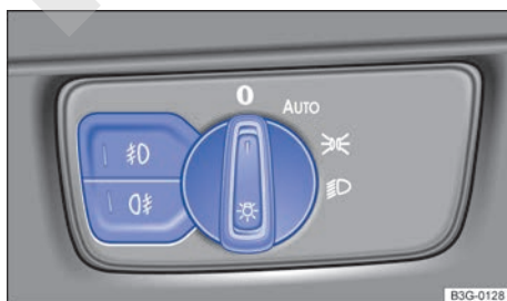
Fig. 106 Junto al volante: mando de las luces (una variante).
