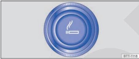
Fig. 180 En la parte delantera o en la parte inferior de la consola central: encendedor.
