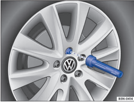
Fig. 276 Cambio de rueda: desenroscar los tornillos de rueda con el mango del destornillador.
