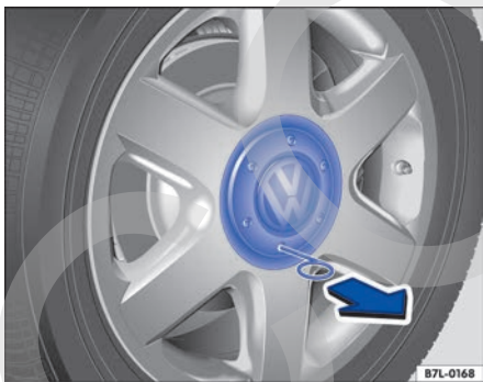
Fig. 267 Desmontar el tapacubos central tirando de él.
