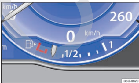
Fig. 23 Indicador del nivel de combustible en el Active Info Display.
