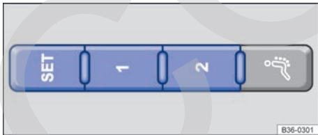
Fig. 101 En el lateral exterior del asiento del conductor: teclas de memoria.
