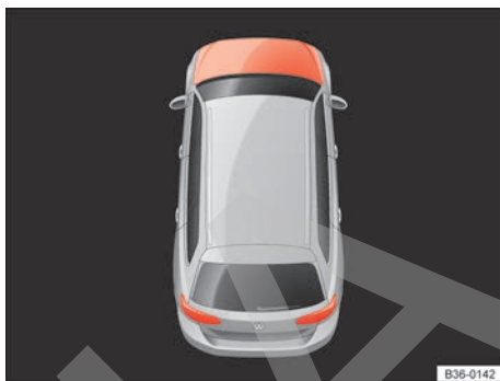
Fig. 251 En la pantalla del cuadro de instrumentos: capó del motor abierto o no cerrado correctamente.
