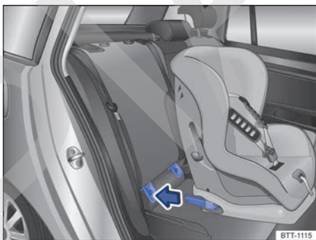
Fig. 60 Representación esquemática: montaje de un asiento para niños ISOFIX con conectores.
