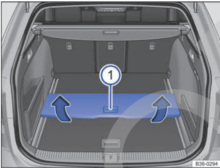
Fig. 194 En el maletero: desmontar el piso desplazable del maletero.
