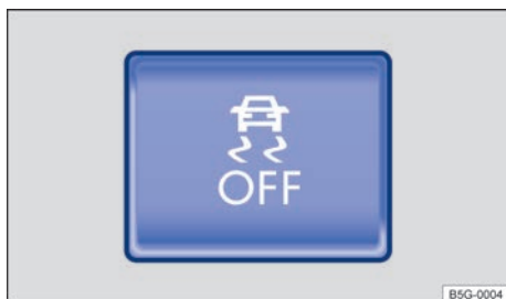
Fig. 169 En la consola central: tecla para desconectar y conectar manualmente el ASR.
