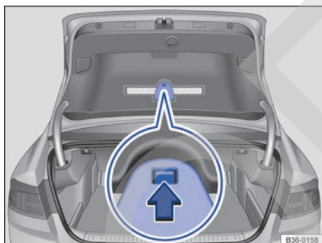
Fig. 68 En el portón del maletero: soporte del triángulo de preseñalización (berlina).
