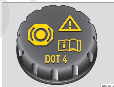
Fig. 257 En el vano motor: tapa del depósito del líquido de frenos.
