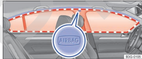
Fig. 52 En el lado izquierdo del vehículo (berlina): ubicación y zona de despliegue del airbag para la cabeza.
