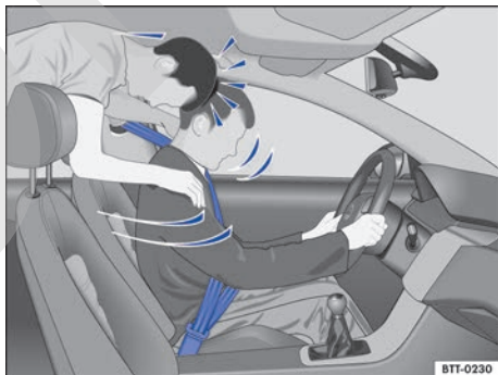
Fig. 39 El ocupante del asiento trasero sin el cinturón de seguridad colocado sale lanzado hacia delante topando contra el conductor, que sí lo lleva colocado.
