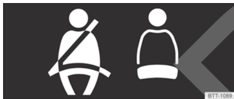
Fig. 35 En la pantalla del cuadro de instrumentos: indicación del estado de los cinturones de seguridad de las plazas traseras.
