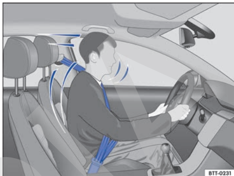
Fig. 40 Los conductores que lleven el cinturón de seguridad correctamente colocado no saldrán lanzados en caso de un frenazo.
