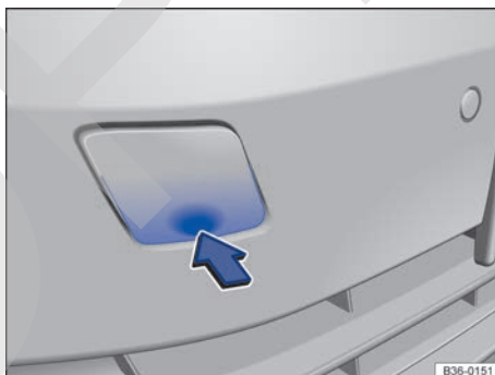
Fig. 247 En el lado derecho del paragolpes delantero: retirar la tapa.
