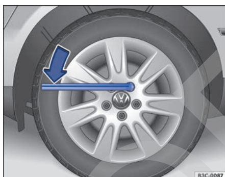
Fig. 271 Cambio de rueda: aflojar los tornillos de rueda.
