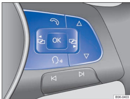
Fig. 28 Lado derecho del volante multifunción: teclas para utilizar los menús y las indicaciones informativas del cuadro de instrumentos.
