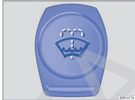
Fig. 252 En el vano motor: tapa del depósito del líquido lavacristales.
