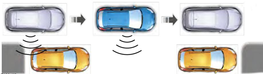
**Nota:** Asimismo, puede activar el sistema después de sobrepasar parcial o completamente un espacio de estacionamiento. Presione el botón de asistencia activa de estacionamiento y el sistema le informará si recientemente pasó un espacio de estacionamiento adecuado.
