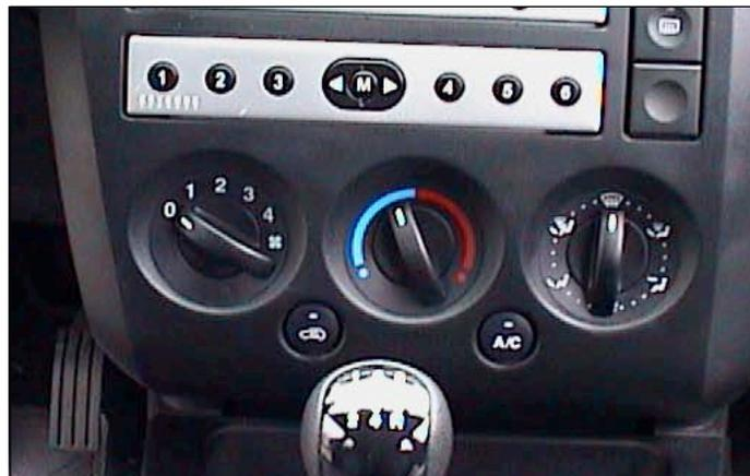
Tutti i comandi per la regolazione della temperatura si trovano nella consolle centrale del cruscotto. È composto da tre manopole attraverso le quali si possono impostare: la velocità della ventola, la temperatura all'interno dell'abitacolo e la distribuzione dell'aria.
