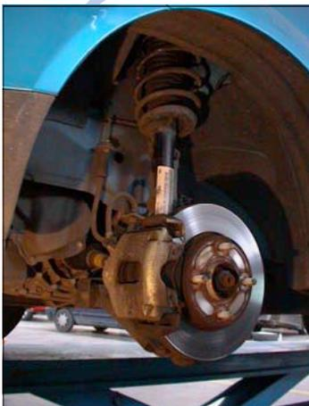
Viene utilizzata una nuova sospensione anteriore Mc-Pherson con bracci trasversali ad L.
