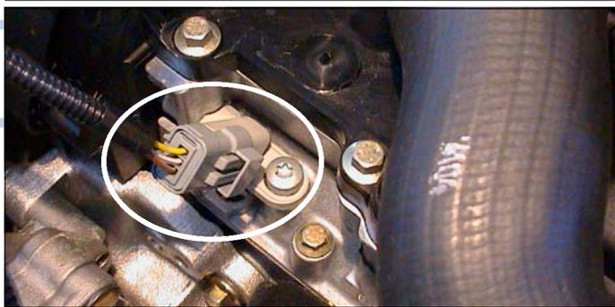
Il sensore CMP funziona secondo l'effetto Hall e sfrutta l'ingranaggio dell'albero a camme come punto di riferimento per riconoscere il cilindro n. 1.
