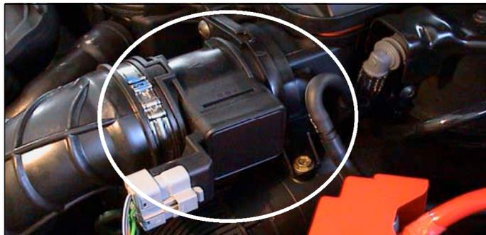
Il sensore MAF si trova all'uscita della scatola filtro dell'aria e rileva la
