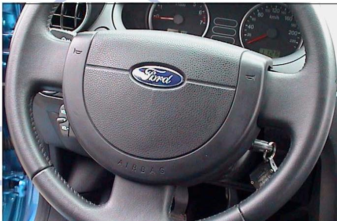
Se il rallentamento in caso di impatto frontale superasse un determinato valore, viene attivato innanzitutto sul lato guida il primo generatore di gas e successivamente il secondo generatore di gas. L'intervallo di tempo tra l'attivazione del primo e secondo generatore di gas dipende direttamente dall'entità dell'incidente e dai segnali emessi dalla centralina Air Bag.
