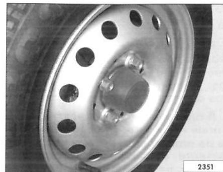
Substitua a roda, coloque os parafusos, iniciando pelo superior, e aperte-os levemente. Nunca lubrifique os parafusos. Apenas limpe-os antes de instalá-los.
