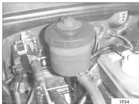
Com o veículo nivelado, motor desligado e as rodas alinhadas, o nível deve estar entre as marcas "MÁX." e "MÍN." do reservatório (o óleo liberado está disponível no seu Concessionário Volkswagen).
