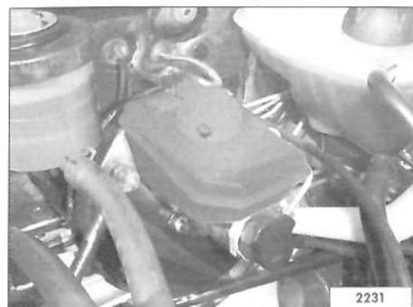
A tampa do reservatório possui furo de respiro, que nunca deve estar obstruído. Transparente, permite a verificação do nível do fluido, que deve encontrar-se entre as duas marcas (MÁX. e MÍN.). É normal o nível abaixar devido ao desgaste das pastilhas. Procure o auxílio de um Concessionário Volkswagen, se perceber indícios de vazamento. Utilize somente Fluido de Freio Original VW e evite qualquer derramamento, pois o fluido ataca a pintura. Nunca misture fluidos de freio diferentes.
