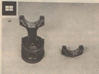
Esquema de montaje del conjunto biela-pistón en el cilindro.
