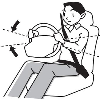
Con el motor en ralentí, coloque el volante en posición recta y, a continuación, gire suavemente hacia ambos lados y compruebe el juego libre del volante desde la distancia periférica hasta el punto en que los neumáticos empiezan a moverse.
