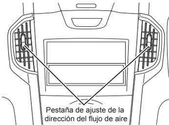
Utilice la pestaña para ajustar la dirección de salida del flujo de aire. Para cerrar la salida, mueva la pestaña completamente hacia abajo.
