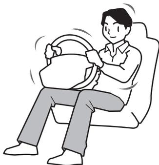
Sujete el volante con las dos manos y muévalo en la dirección del eje, así como arriba y abajo y hacia los lados para comprobar si hay flojedad.
