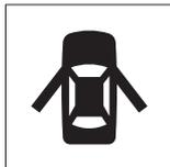
La luz de advertencia de puerta abierta si enciende si alguna puerta no está correctamente cerrada al poner el interruptor de arranque en la posición "ON".
