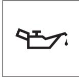
Esta luz de advertencia debe encenderse cuando se gira el interruptor de arranque a la posición "ON" y después apagarse cuando el motor haya arrancado.
