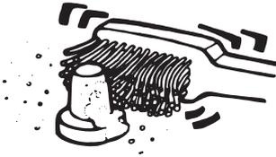
1. Compruebe que los terminales no presenten flojedad, grietas ni corrosión. Si el terminal presenta grietas, acuda a un Concesionario Chevrolet para que lleven a cabo una revisión y sustitución.
