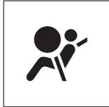
La luz de advertencia del airbag SRS debe parpadear siete veces cuando el interruptor de arranque se coloca en la posición "ON" y, a continuación, debe apagarse.
