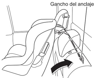
4. Coloque el gancho del anclaje en el anclaje superior.
