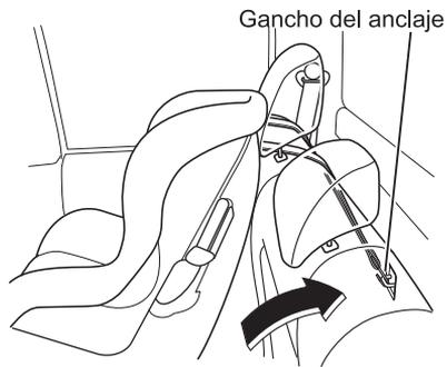
5. Afloje la correa de anclaje del CRS.
