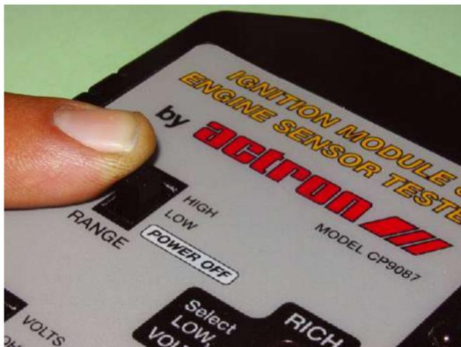
Coloca el selector de función en FREQUENCY.
