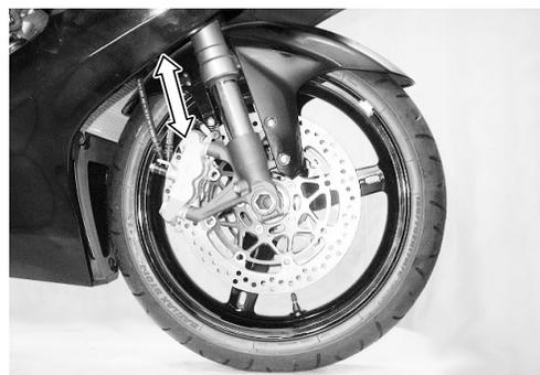
• Apriete los dos tornillos de apriete del eje ① en la pata derecha de la horquilla delantera al par especificado.
