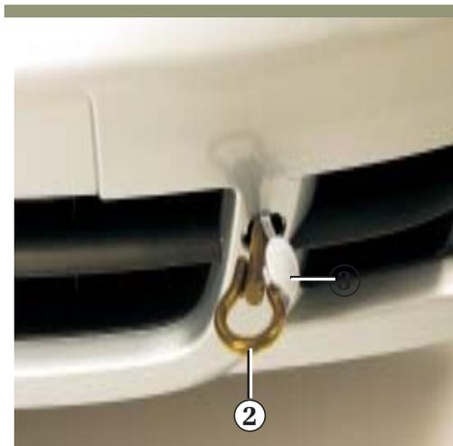
Utilize exclusivamente o engate para reboque 2 (situado no jogo de ferramentas 1) e o ponto de reboque 3 (nunca os eixos de transmissão). Desclipsar a tampa para fixação do engate.
