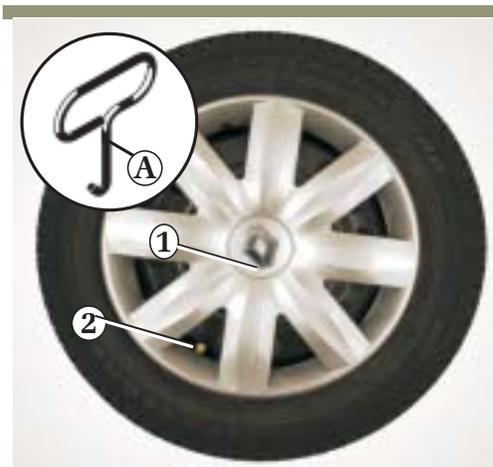
Para recolocá-la, encaixe-a, tendo o cuidado de orientá-la em função da válvula **2**.
