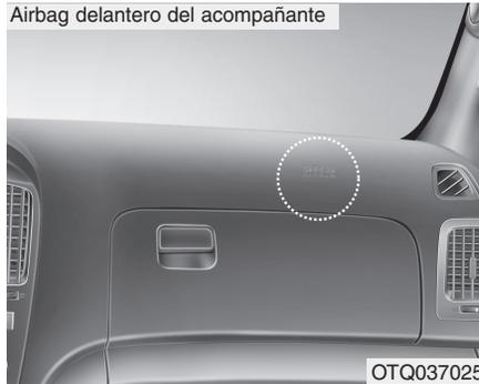
La finalidad del SRS es proporcionar al conductor del vehículo y al acompañante una protección complementaria a los cinturones de seguridad en caso de impacto frontal de gravedad.
