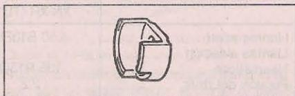
Placa de apoyo del extractor de rodamiento (-).0615EY
